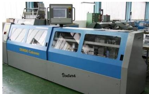
Slika 17. stroj za šivanje koncem
