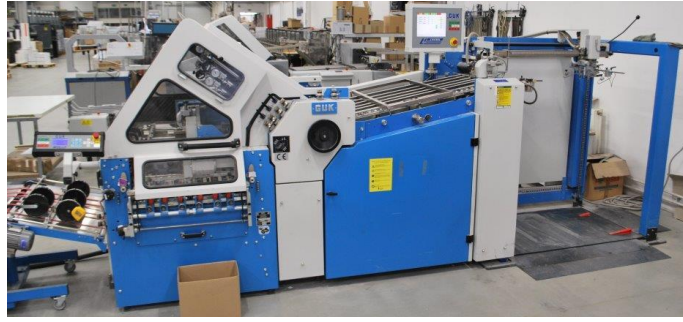
Slika 14. Stroj za savijanje tiskovnih podloga - Savijačica
