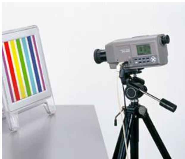
Slika 13. Konica Minolta CS-200 kolorimetar
