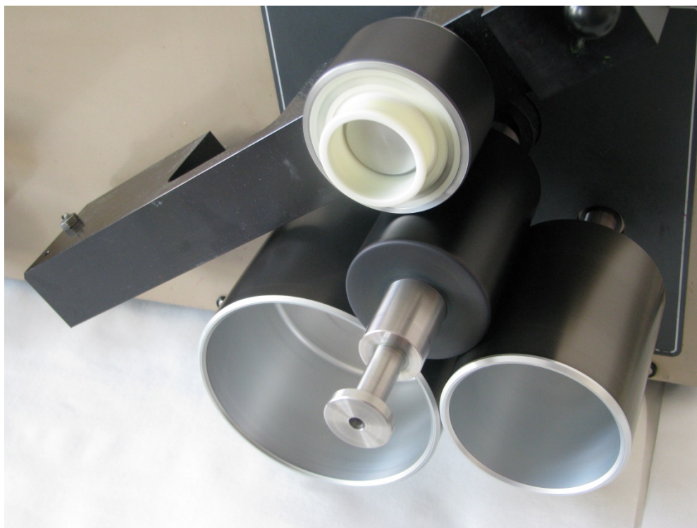
Slika 21. Sustav valjaka na IGT C1 stroju
