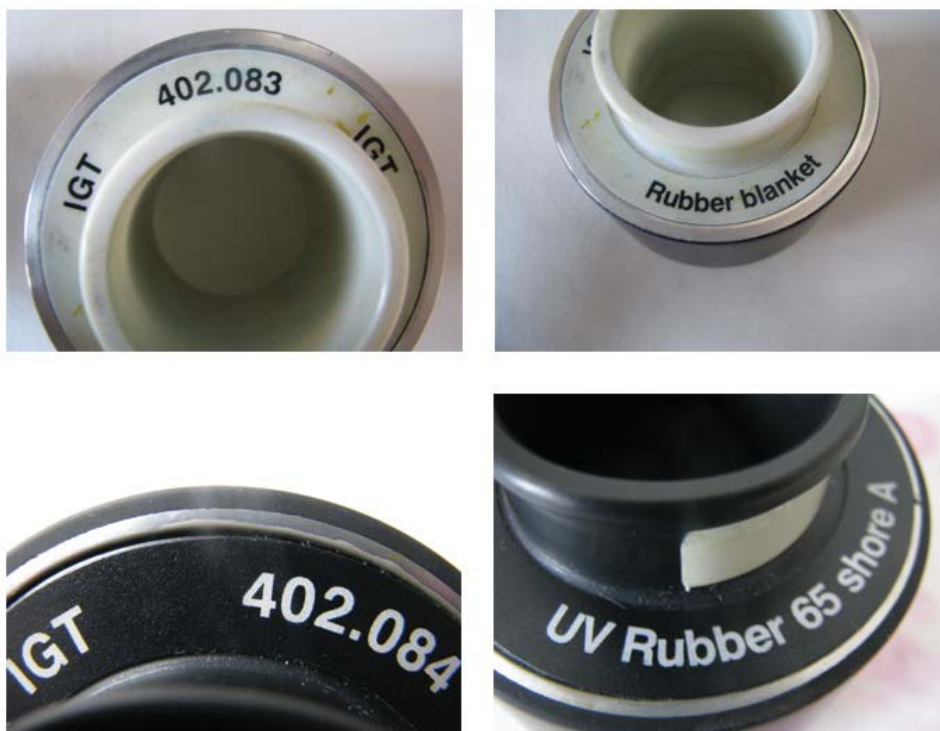
Slika 22. Valjci korišteni za ofset i UV ofset boje
