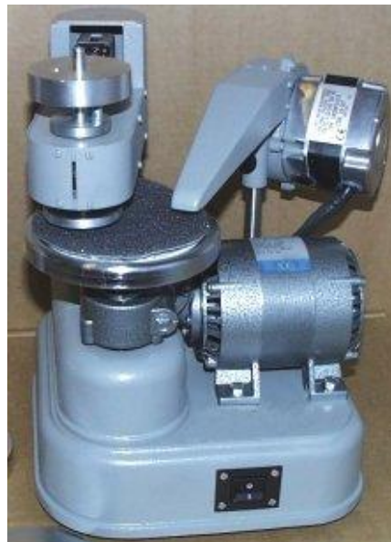
Slika 16: Uređaj za ispitivanje otpornosti otisaka na otiranje Wallace
