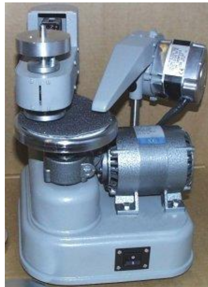
Slika 16: Uređaj za ispitivanje otpornosti otisaka na otiranje Wallace
