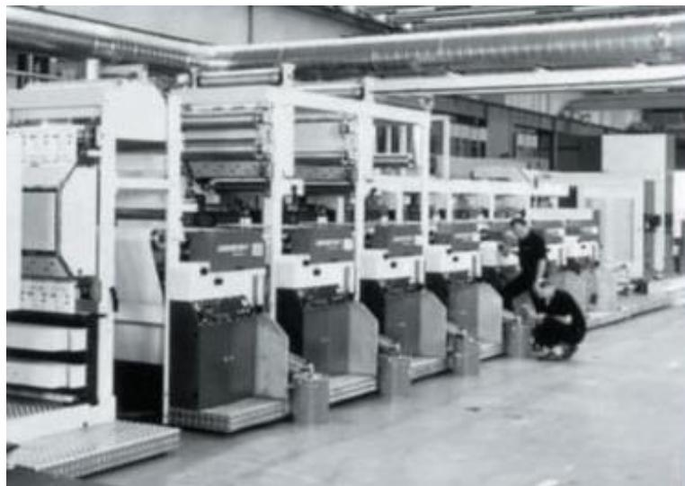
*Slika 4. Rezervoari s bojilom smješteni uz tiskovne jedinice rotacije Lemanic 82 F
