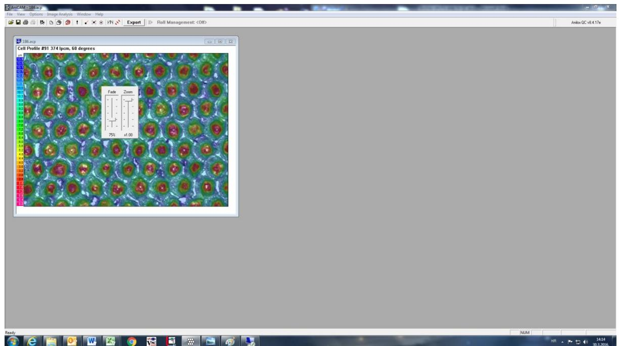
U našem slučaju smo mjerili aniloks u 3 točke po 3 mjerena za BHS stroj , dopušteno je do 5 točaka po 5 mjerena. Mjeri se pomoću opcije **Average Measure Mode** koji se podeši po željenim parametrima.
