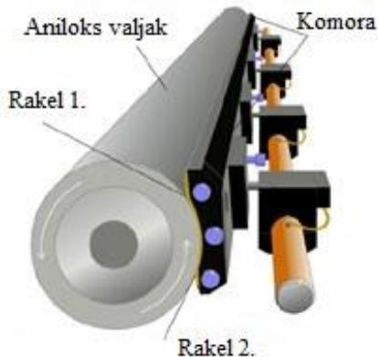
*Slika 1. Prikaz direktnog dovoda bojila na aniloks valjak*
