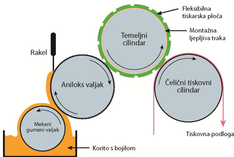
*Slika 6. Sustav za obojenje s klasičnim rakelom*
