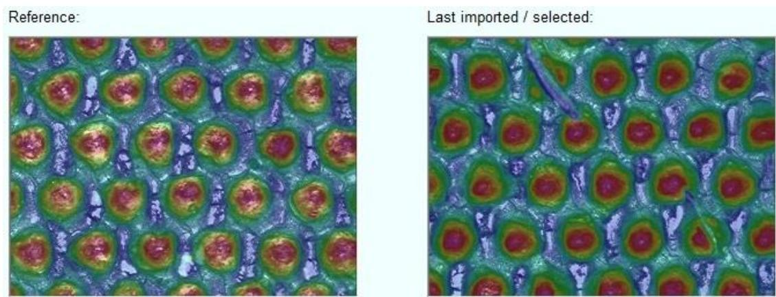
*Slika 19.(a) čisti rasters, (b) zaprljeni raster*
