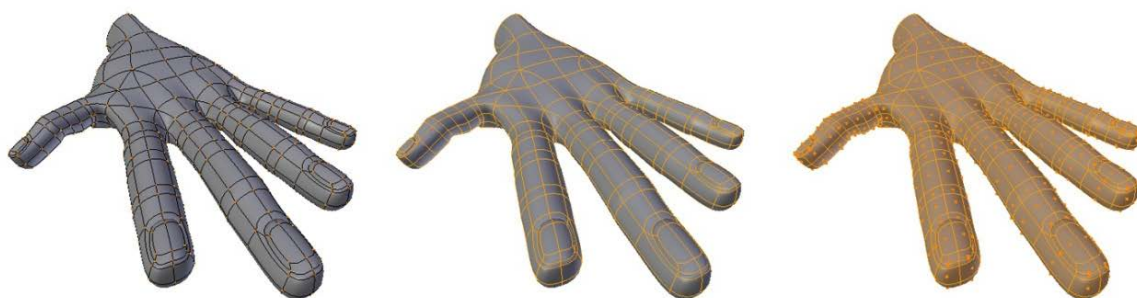
Slika 4. Prikaz 3D modela; lijevom modelu su označene točke (eng. vertices), u sredini model na kojem su označene linije (eng. edges), te na desnoj strani model kojem su označene plohe (eng. faces).
