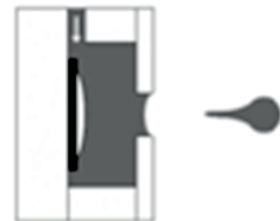
Slika 21. Formiranje kapljice tehnologijom termalnog Inkjeta
