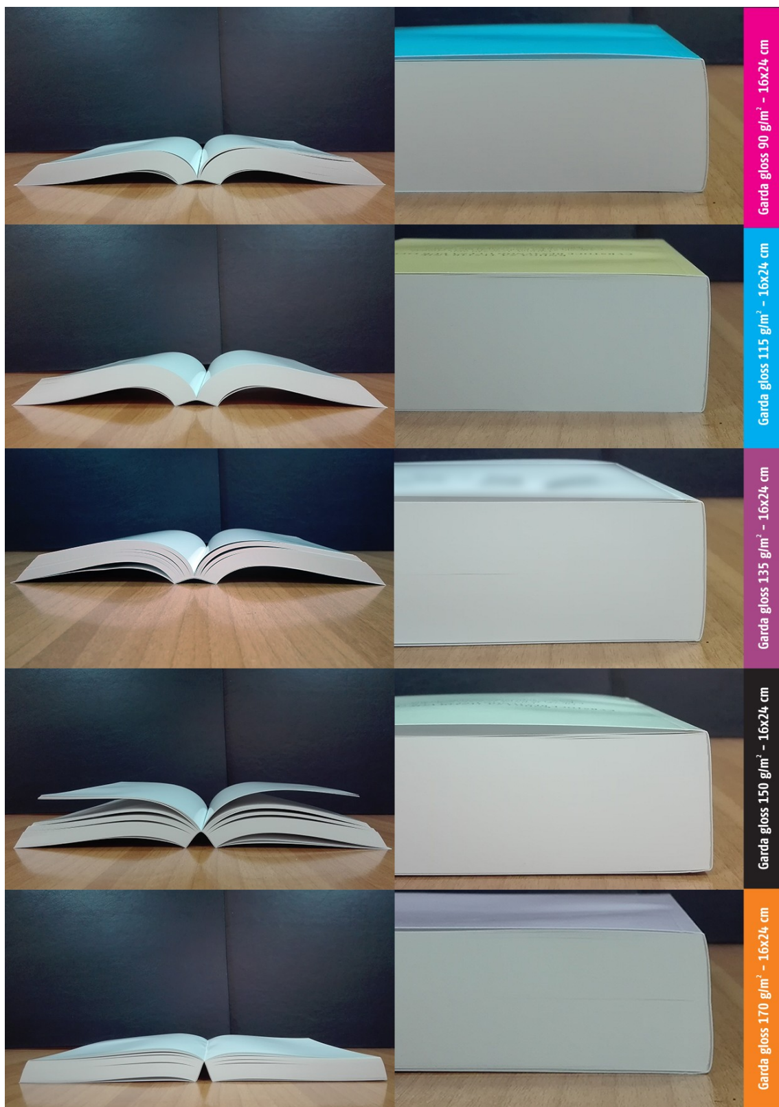
Slika 25. Knjige formata 16x24 cm, izrađena od papira garda gloss 90 g/m 2 , 115 g/m 2 , 135 g/m 2 , 150 g/m 2 , 170 g/m 2 , prikaz otvaranja knjige i deformacije hrpta
