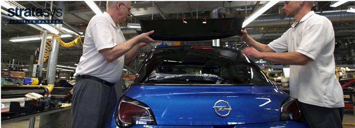
Slika 3. Opel koristi 3D printane alate za sastavljanje u proizvodnji
