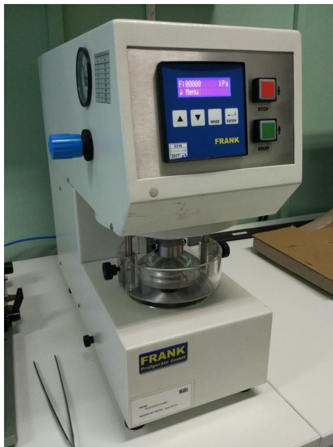
Slika 26: Uređaj za BST ispitivanje
