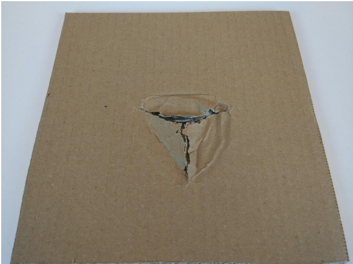
Slika 29: uzorak za određivanje otpornosti valovite ljepenke prema dinamičkom probijanju
