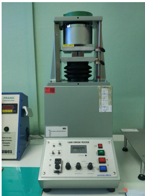
Slika 25: Uređaj za ECT ispitivanje
