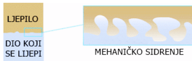
Slika 2. Prikaz mehaničkog sidrenja
