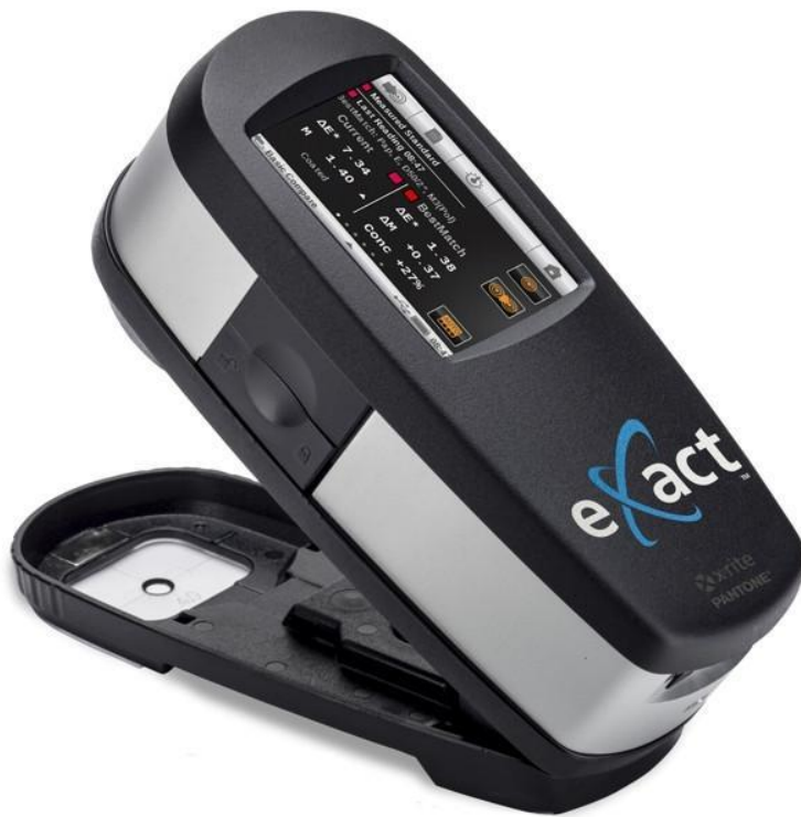
Slika 7: Denzitometar X-Rite Exact
