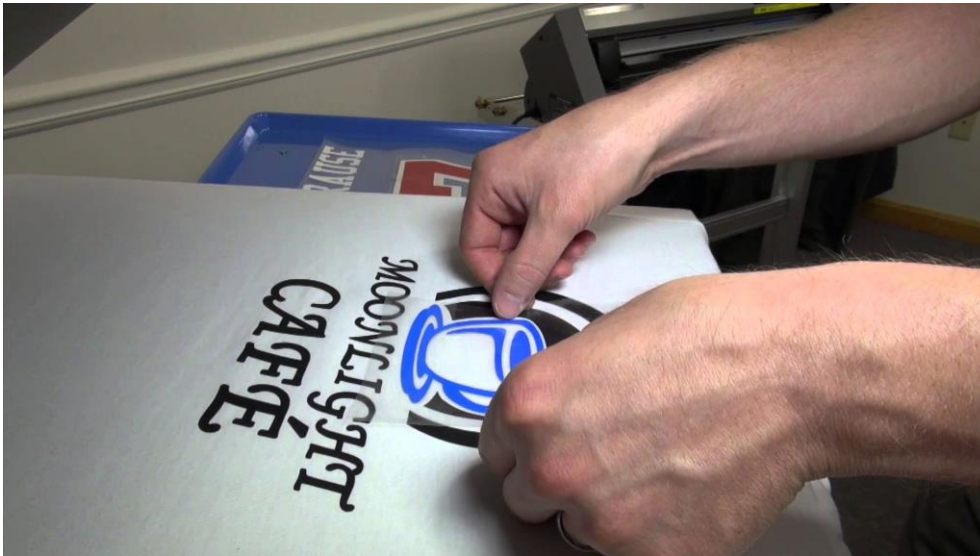
Slika 2: kombiniranje folija kod termo tiska
