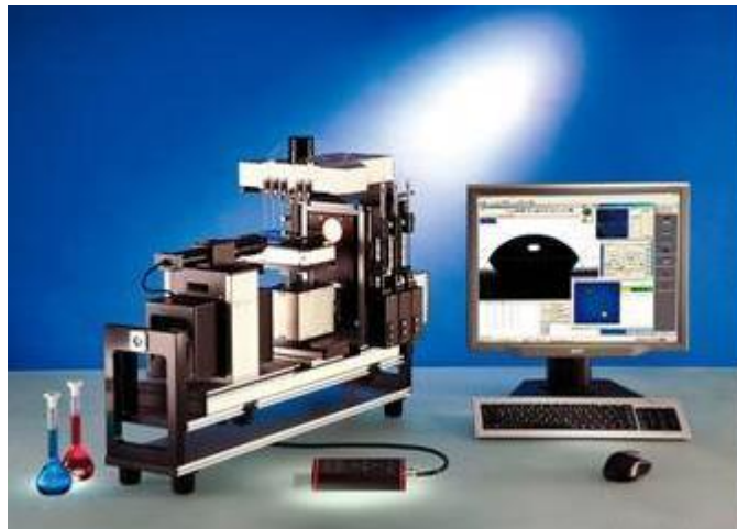
Slika 15. Optički goniometar Dataphysics OCA
