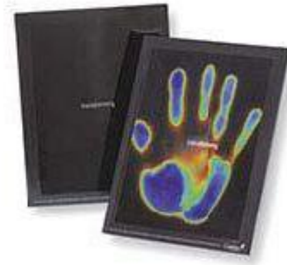
Slika 3 - Primjena tekućih kristala. Kontinuirana promjena obojenja duž cijelog vidljivog spektra
