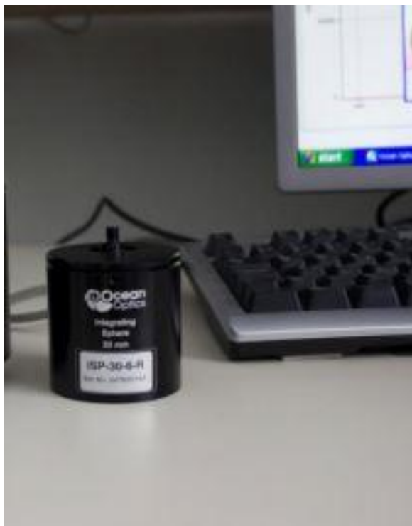
Slika 13 – Integracijska sfera OcenOptics ISP-30-6-R-GT
