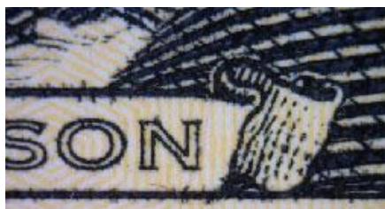
Slika 25 Dio portreta otisnut intaglio tiskom na novčanici od 20 USD
