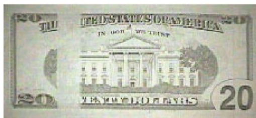
Slika 53 Naličje novčanice od $20 pod IR svjetlom
