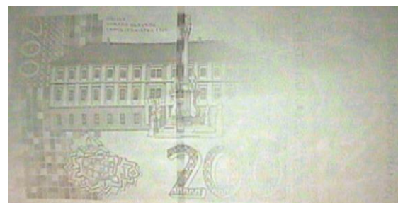
Slika 59 Naličje novčanice od 200 HRK pod IR svjetlom
