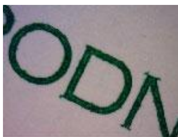
Slika 27 Dio natpisa "HRVATSKA NARODNA BANKA" na licu novčanice od 200 HRK izveden ispupčenim tiskom
