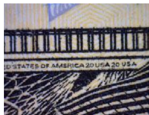
Slika 26 Dio vinjete i mikrotiska otisnuti intaglio tiskom na novčanici od 20 USD
