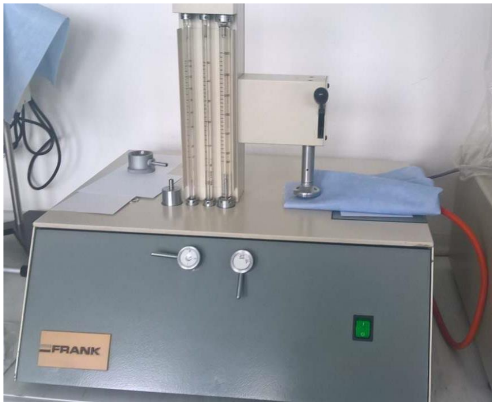
Slika 13. Frank Bendtsen Roughness Tester
