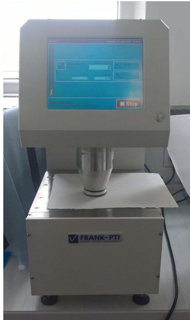
Slika 14. PTI Austria GmbH PTA line BEKK tester
