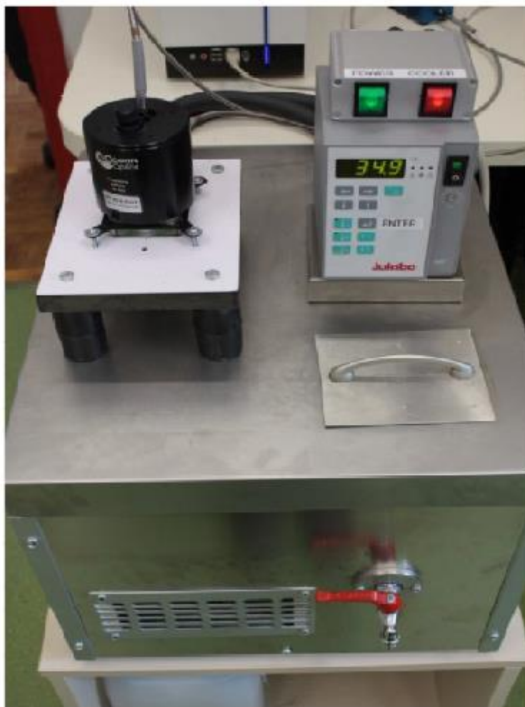
Slika 15. Uređaj za zagrijavanje/hlađenje uzoraka
