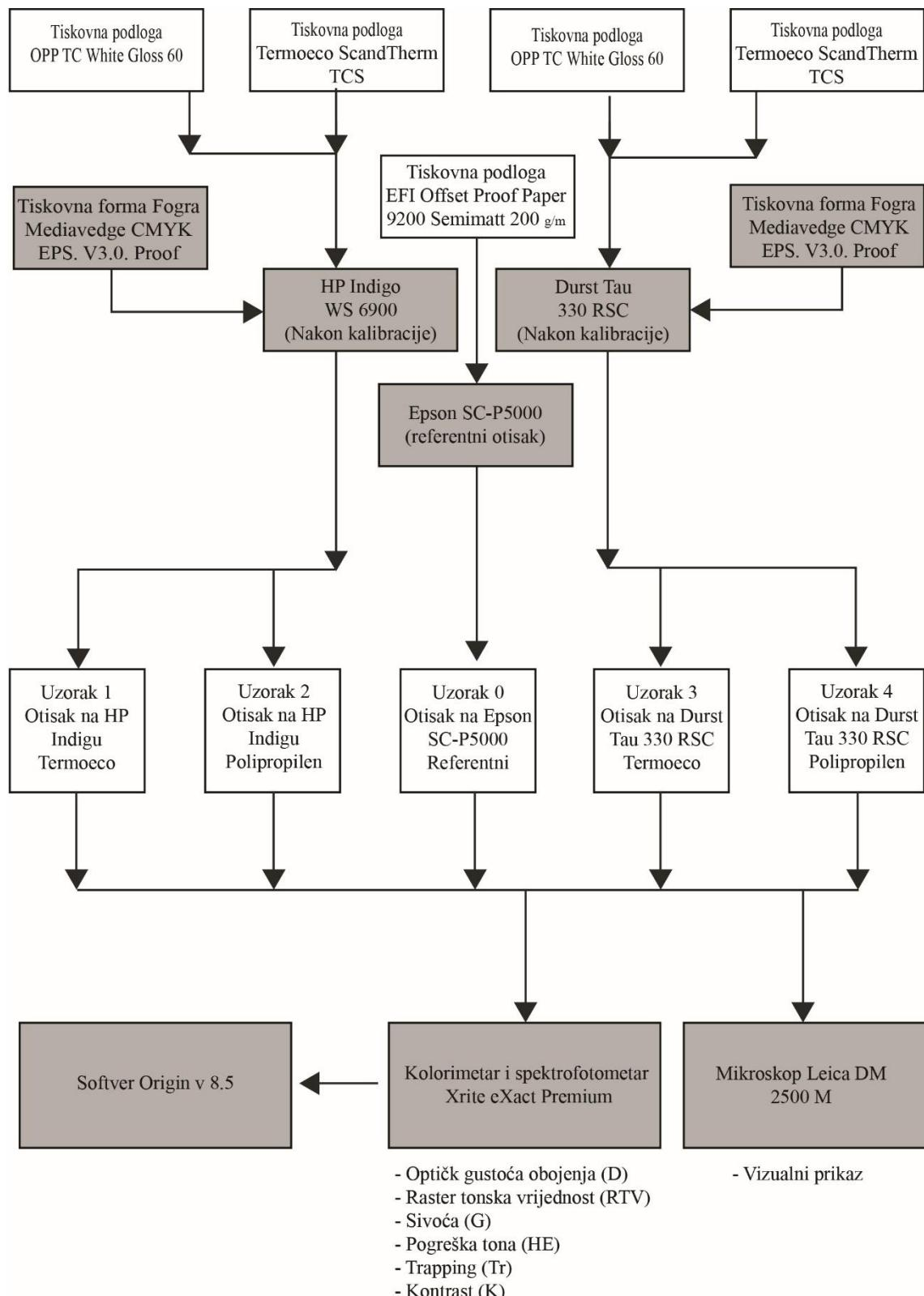
Slika 33 Shematski prikaz plana eksperimentalnog rada
