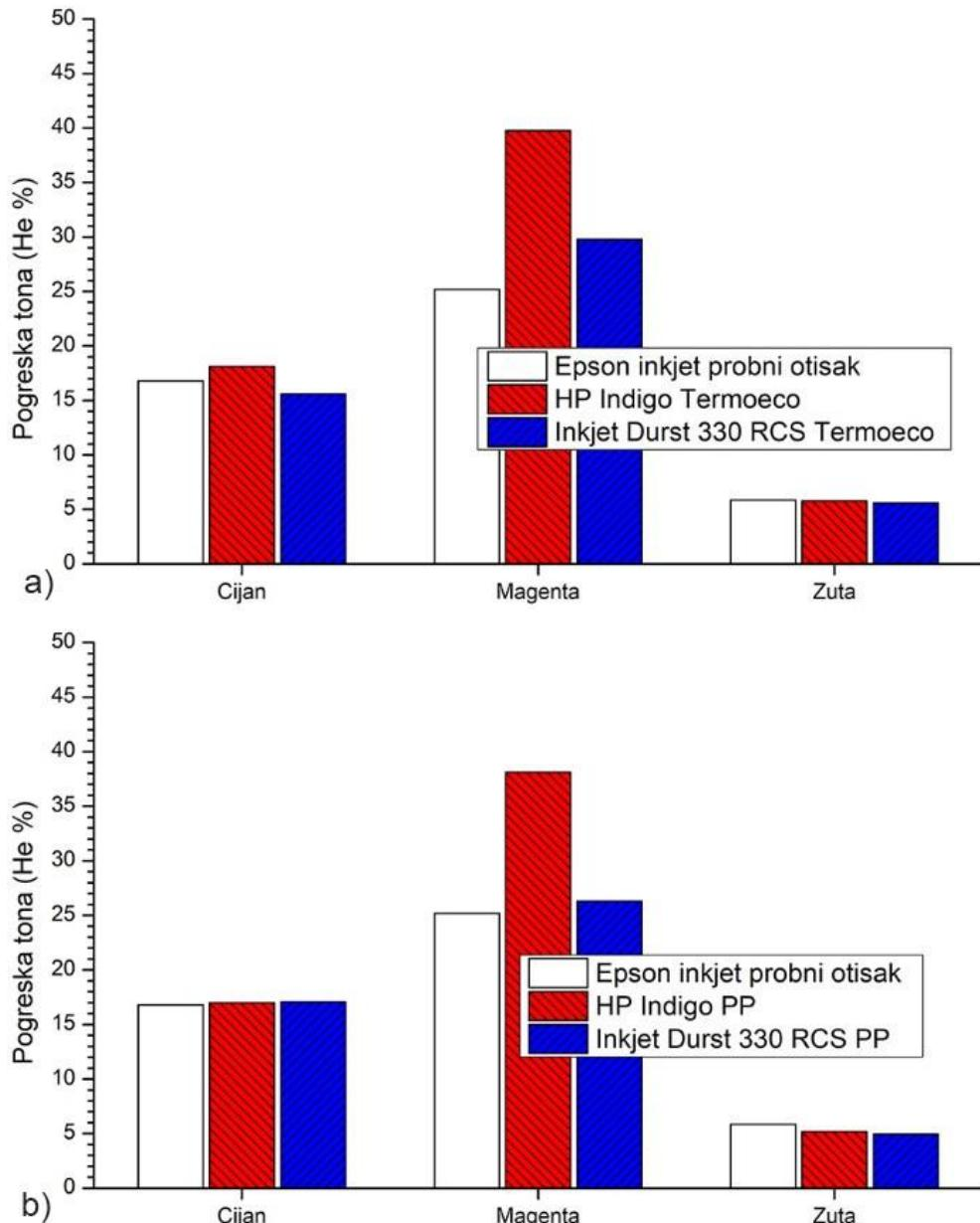
Slika 47 Pogreška tona CMY separacija za tiskovne podloge: a)Termoeco ScandTherm TCS b) Arconvert OPP TC WHITE GLOSS 60
