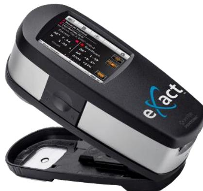
Slika 37 Mjerni uređaj X-Rite eXact advance
