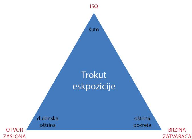
Slika 12. Međuvisinost otvora zaslona, brzine zatvarača i ISO osjetljivosti
