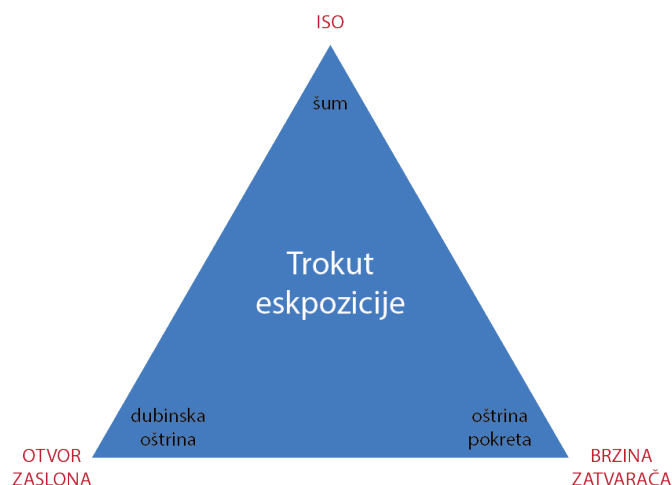
Slika 12. Međuovisnost otvora zaslona, brzine zatvarača i ISO osjetljivosti
