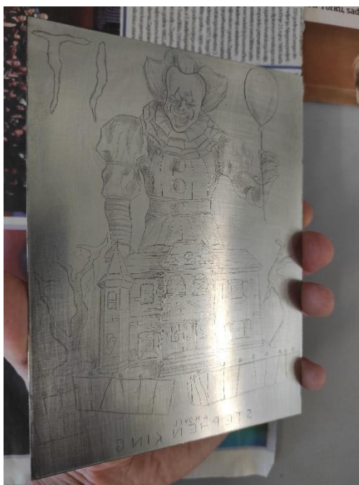
Slika 16. Tiskovna forma nakon jetkanja
