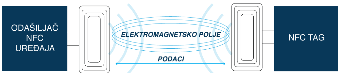
Slika 11. Grafički prikaz principa rada NFC-a
