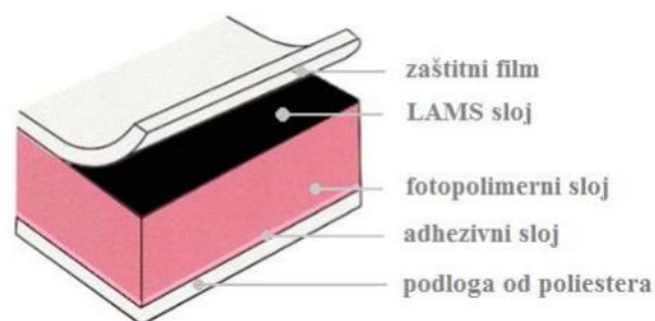
Slika 8. Presjek tiskovne forme s LAMS slojem [3]
