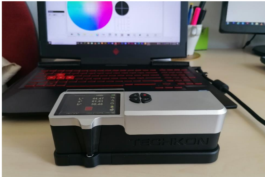
Slika 21. Spektralni denzitometar TECHKON SpectroDens
