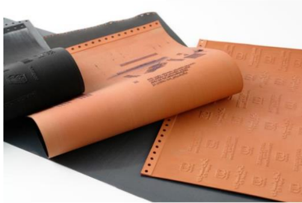
Slika 4. Gumena tiskovna forma [3]
