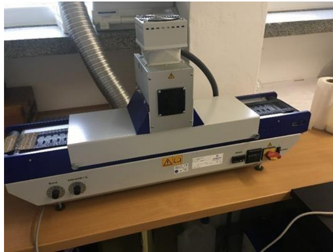
Slika 12. UV sušač Technigraf Aktiprint L 10-1
