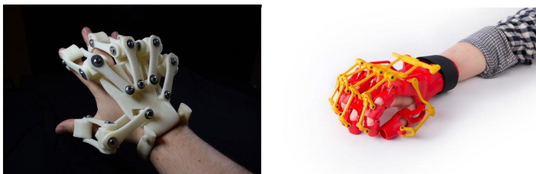
Slika 24. Prikaz isprintane 3D proteze za rehabilitaciju.
