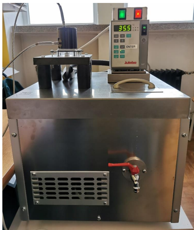
Slika 11. Uredaj za zagrijavanje/hlađenje uzoraka
