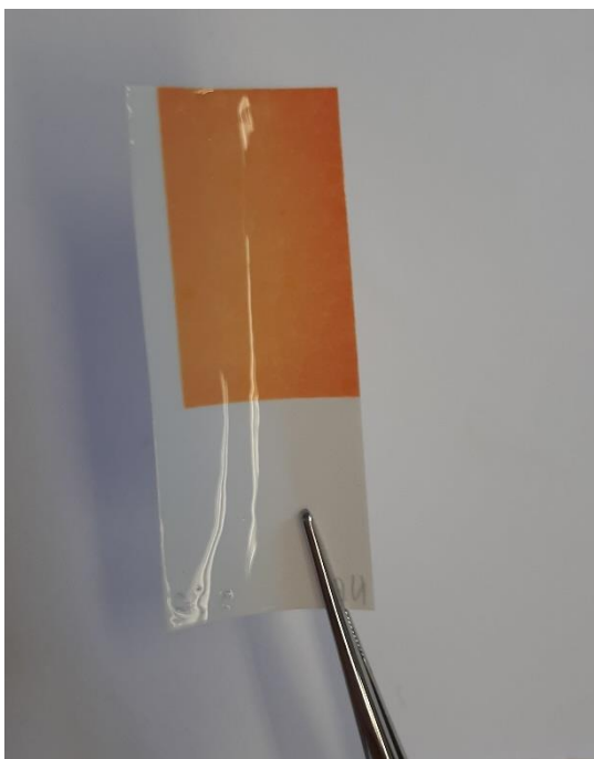
Slika 25 Reakcija TC otiska – narančasto obojenje koje je dokaz niske temperature (ispod 12°C) uslijed reakcije isparavanja etanola na sobnoj temperaturi (23°C)
