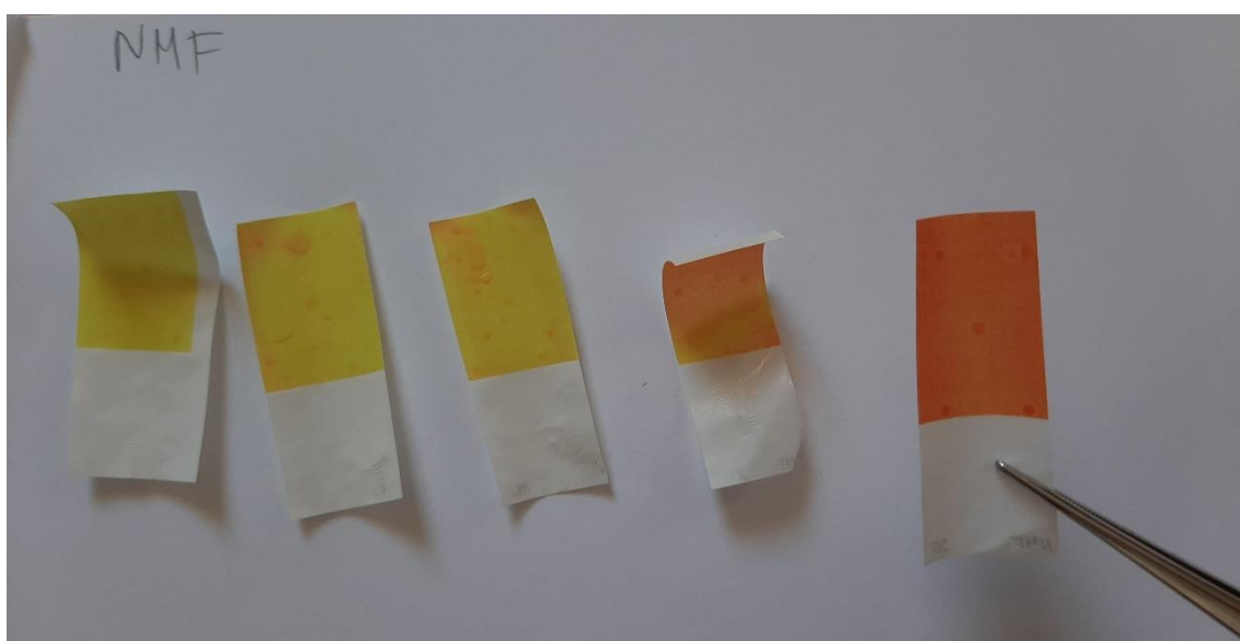
Slika 24 Promjena obojenja otiska uslijed reakcije isparavanja etanola na uzorku NMF
