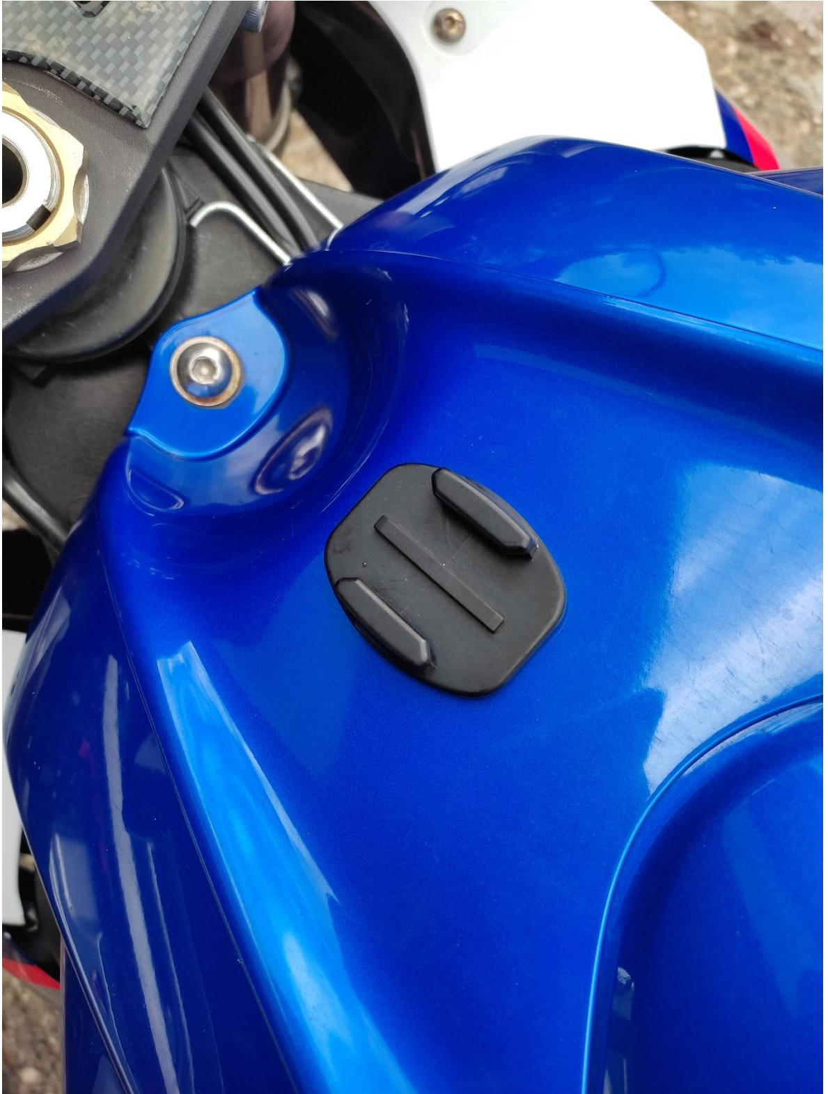
Slika 8- GoPro nastavak za montiranje kamere na rezervoar
