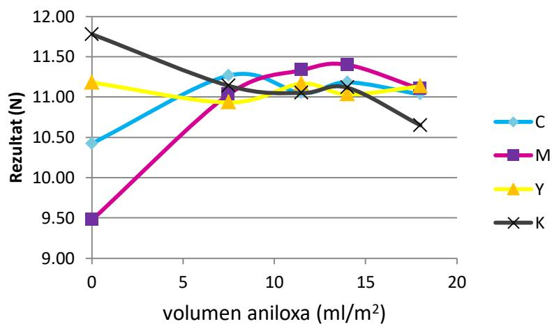
Slika 21. Rezultati otpornosti na savijanje za sjajni papir
