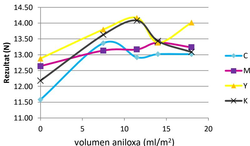
Slika 22. Rezultati otpornosti na savijanje za mat papir
