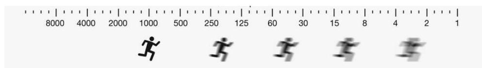
Slika 7: Brzina zatvarača
