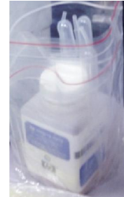
Slika 9. Image Agent = komponenta za povećanje električne provodljivosti
