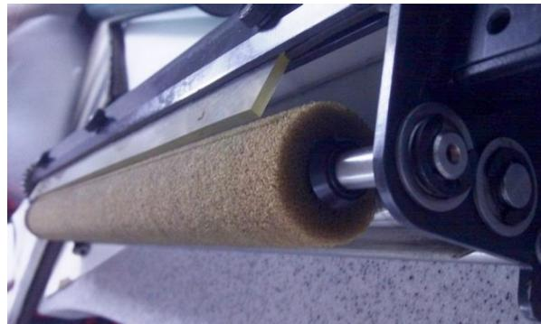
Slika 20. Spužvasti valjak kod jedinice za čišćenje
