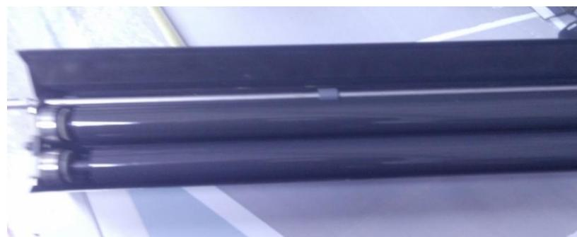
*Slika 16. Razvijači valjci korišteni kod HP Indiga S1000*
