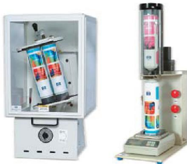
Slika 32. Sistem za miješanje HP IndiChrome bojila (dostupno na: http://h10088.www1.hp.com ,15.07.2013.)
