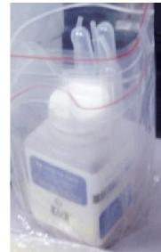
*Slika 9. Image Agent = komponenta za povećanje električne provodljivosti*
