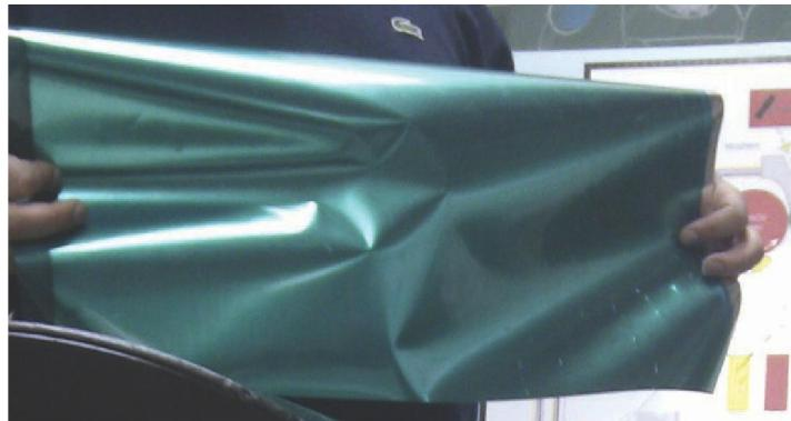
Slika 6. Fotoreceptor kod HP Indiga
