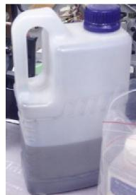
Slikovno ulje je jedan tekući nosioc koji je po kemijskom sastavu Isopar (specijalna frakcija petrolejskog špirita). Bojilo ga sadrži od 70% do 90%, a služi za prenašanje pigmentnih čestica tijekom procesa tiska. Temperatura hlapljenja je vrlo niska te iznosi 50 °C
