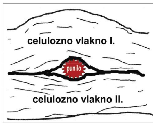
Slika 30. Čestica punila smještena između vlakana [3]
