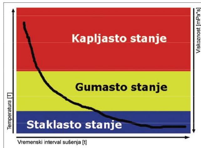
Slika 40. Promjena mehaničkog deformacijskog stanja polimera u tehnološkom procesu sljepljivanja [3]
