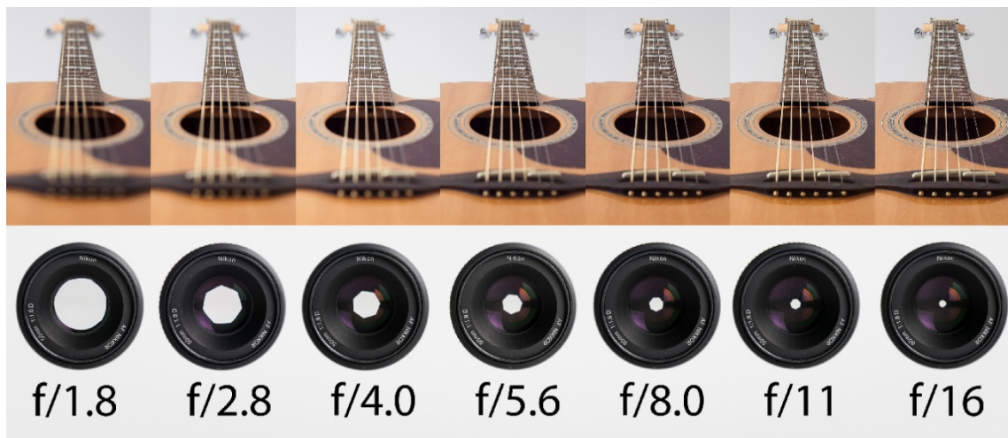
Slika 11. Primjer odnosa dubinske oštine i otvora blende
