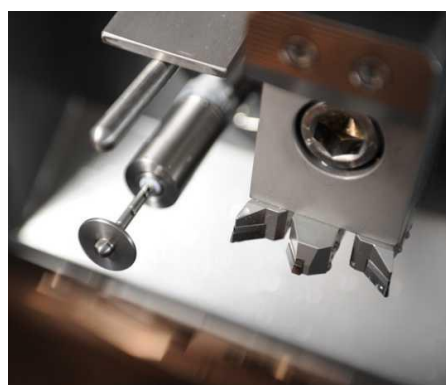
slika 10—modul za mjerenje cilindra sa držačem alata
