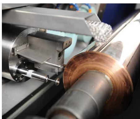
Slika 9—Automatsko mjerenje dimenzija cilindra prije obrade
