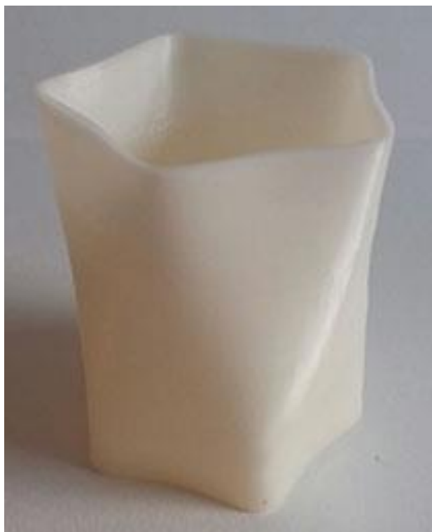
Slika 36. Proizvod tiskan bijelim PLA materijalom
