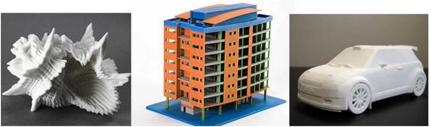
Slika 18. Primjeri 3D tiska 3DP tehnologijom
