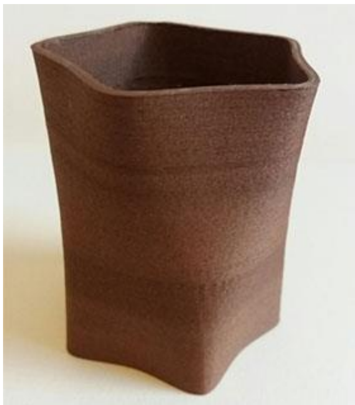
Slika 33. Proizvod tiskan kokos materijalom
