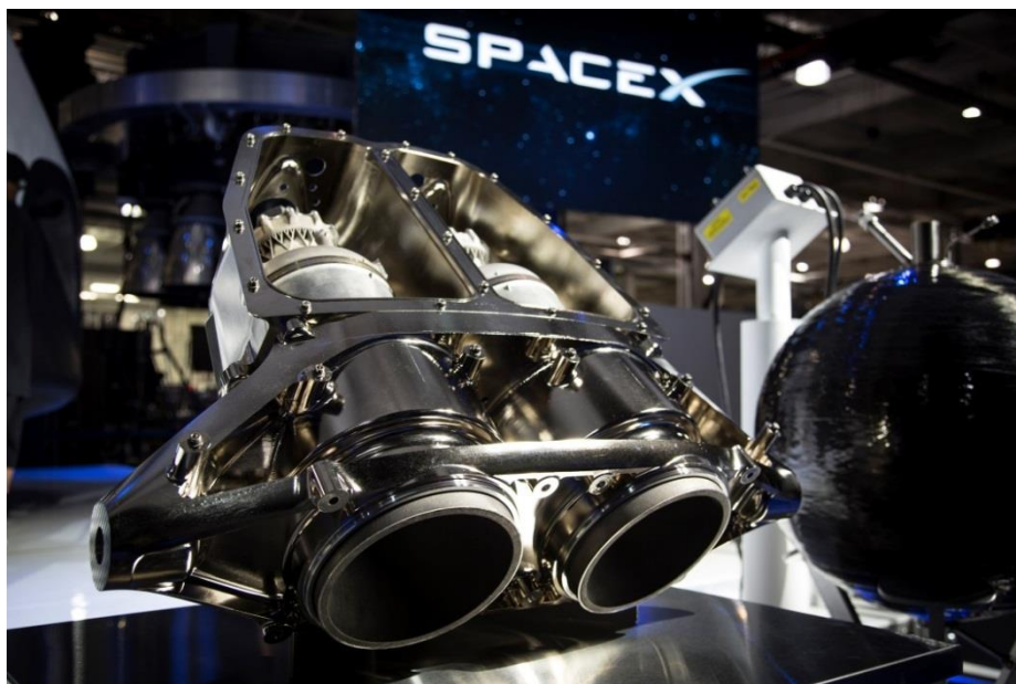
Slika 24. SuperDraco raketni motor izrađen 3D aditivnom tehnologijom
