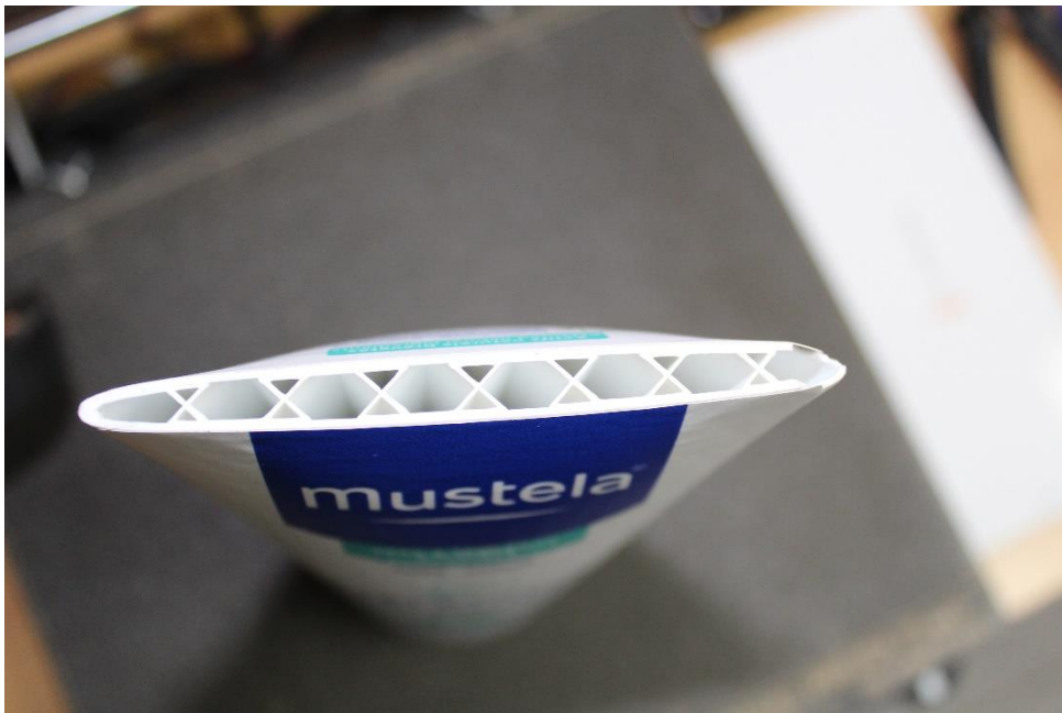
Slika 28. Prikaz unutrašnjosti tube - mrežasta struktura
