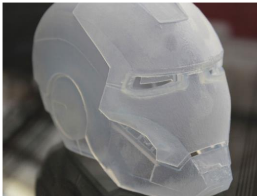
Slika 23. Model napravljen od polikarbonatnog filamenta (Izvor: https://bit.ly/2Wd29cB )
