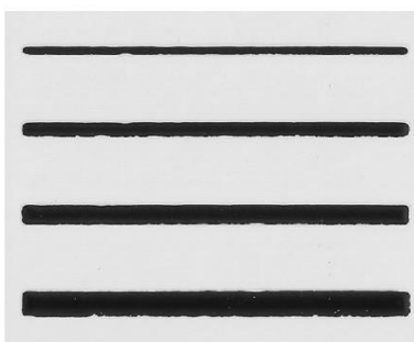
Uzorak 5 (debljina nanosa 43 μm)
