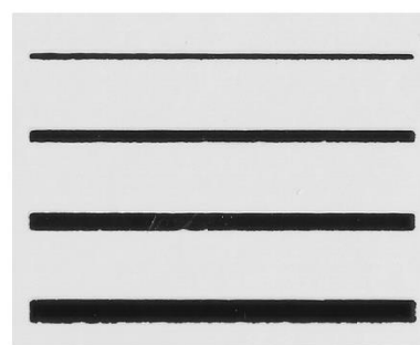
Uzorak 3 (debljina nanosa 29 μm)
