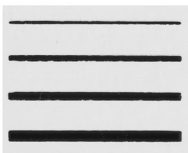
Uzorak 4 (debljina nanosa 36 μm)
