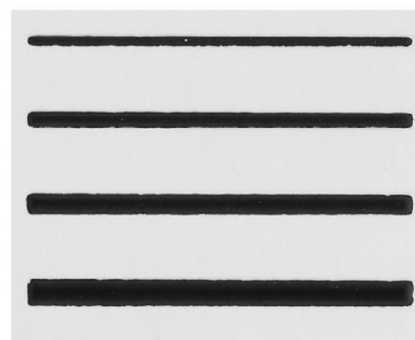
Uzorak 6 (debljina nanosa 51 μm)
