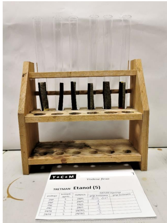
Slika 27. Prikaz segmenta testiranja kemijske otpornosti otisaka na etanol.
