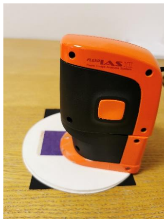
Slika 18. Digitalni mikroskop PIAS-II.
