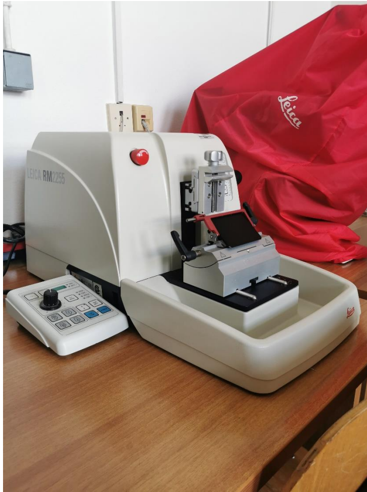
Slika 20. Rotacijski mikrotom uređaj.
