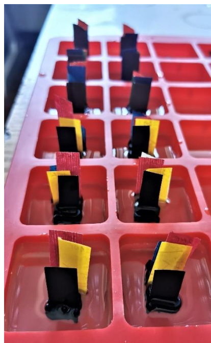
Slika 21. Otisnuti uzorci u epoksi smoli.
