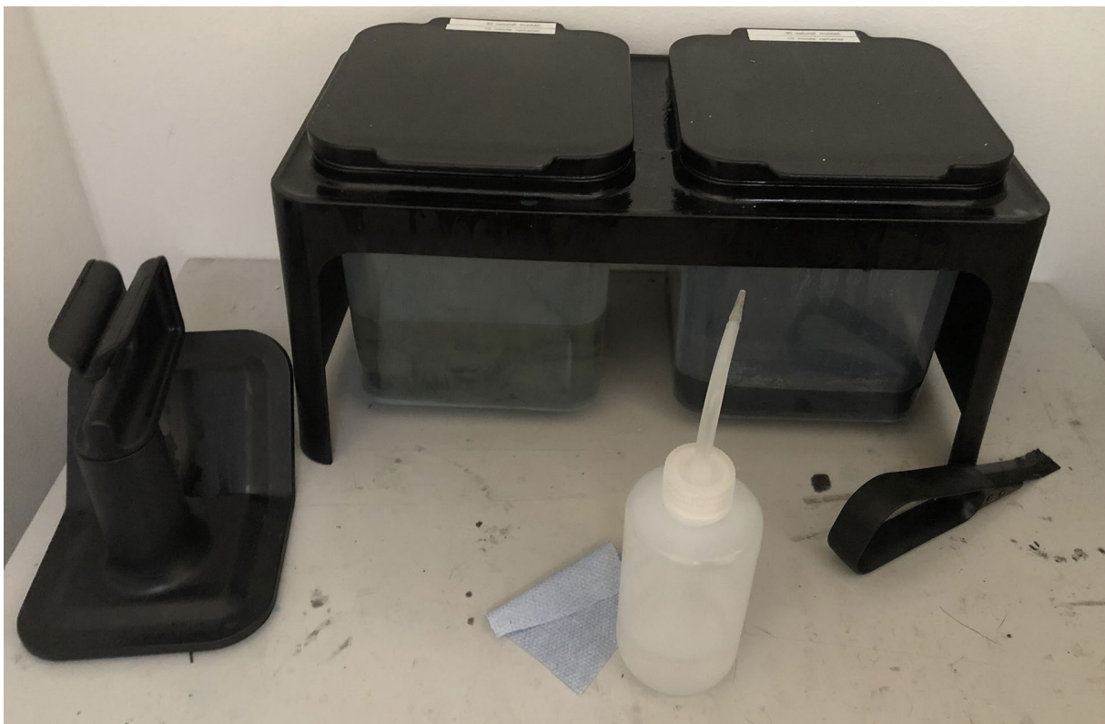
Slika 33 Aparatura za čišćenje modela i uklanjanje strukturnih potpora
