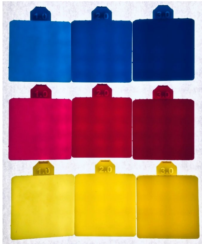
Slika 25 Ispitni uzorci s cijan, magenta i žutim bojilom, debljine 1mm, 2mm, 3mm
