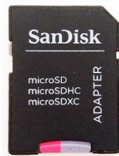
Slika 5. Adapter za umetanje microSD kartice u osobno računalo
