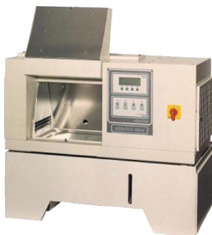
Slika P5.12. Solarbox 1500e komora (poglavlje 3.2.13.)
