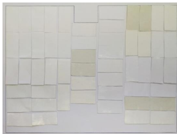
Slika 3.17. Priprema uzoraka za izlaganje UV zračenju u Solarbox komori
