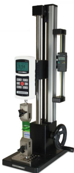
Slika P5.9. MARK 10 ES30 tester s hvataljkama G1015-1 (poglavlja 3.2.6. i 3.2.9.)
