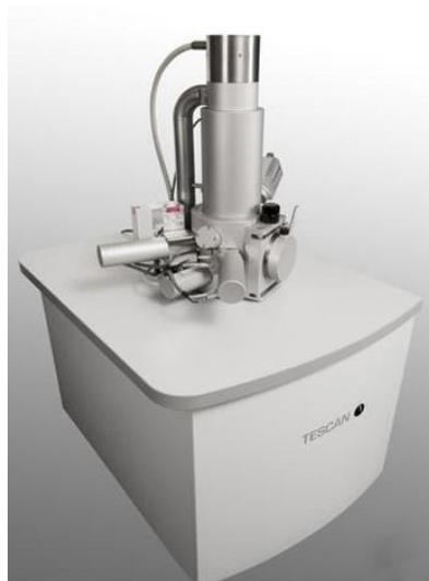
Slika P5.6. Tescan Vega 3 SEM mikroskop (poglavlje 3.2.3.)
