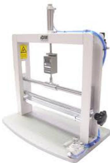
Slika P5.8. IDM Page Pull Tester P0011 (poglavlje 3.2.5.)
