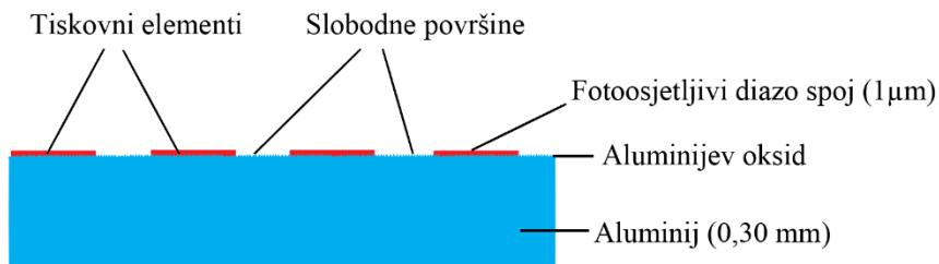
Slika 38. Presjek tiskovne forme za offsetni tiskak
