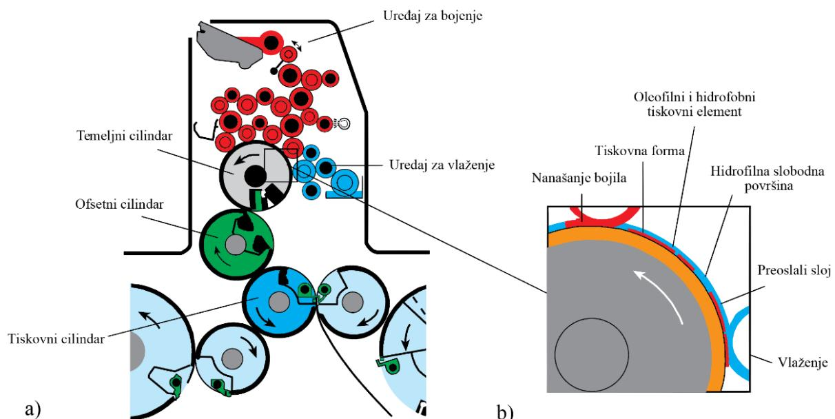
Slika 39. Tiskovna jedinica za offsetni tiskak: a) konstrukcija s tri cilindra, b) zona nanašanja tekućine za vlaženje i bojila
