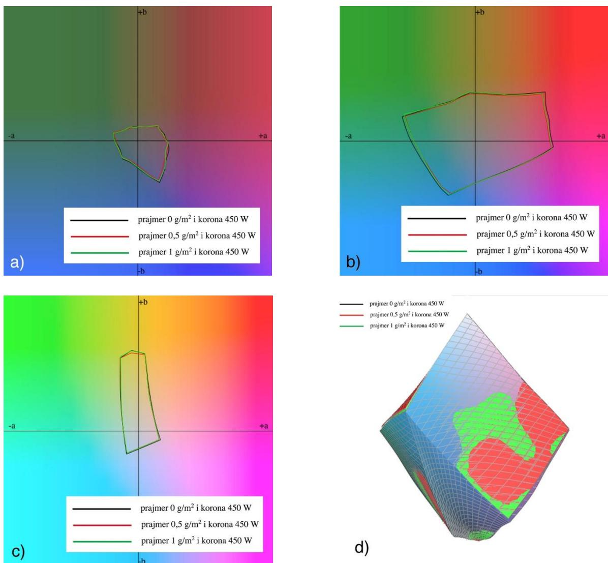
Slika 51. Prikaz gamuta kolorne reprodukcije nastale koronom snage 450 W i devijacijom prajmera: a) presjek  $L = 20$ , b) presjek  $L = 50$ , c)  $L = 80$ , d) 3D prikaz
