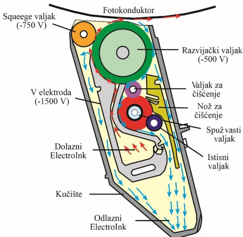
Slika 9. Konstrukcija BID uređaja za nanašanje i razvijanje
