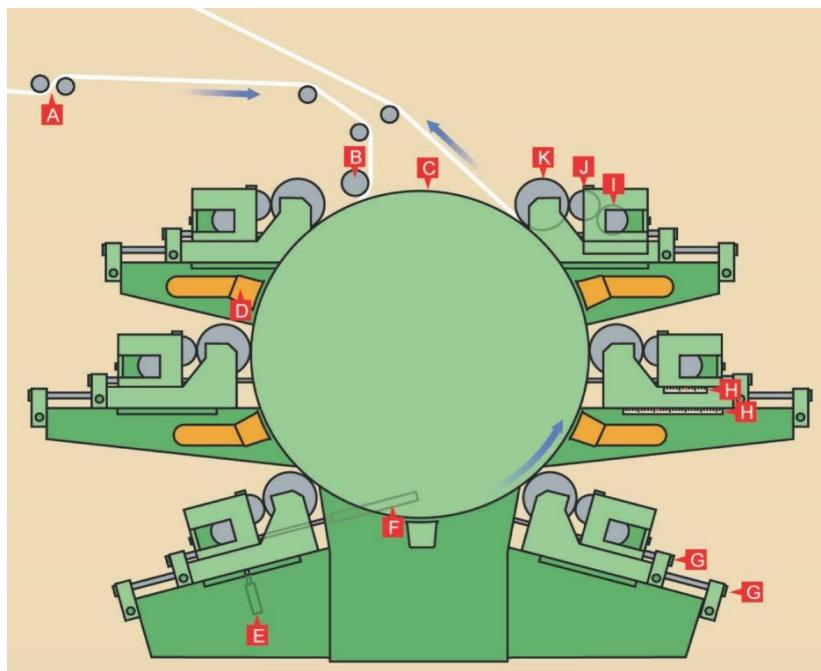
Slika 36. Fleksostroj za premazivanje s centralnim tiskovnim cilindrom
