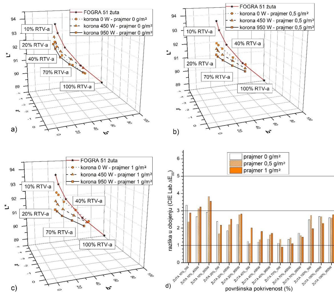
Slika 71. Kolorne promjene žutih otisaka nastale varijacijom nanosa prajmera i napona korone u usporedbi s FOGRA standardom: a) bez prajmera; b) prajmer  $0,5 \text{ g/m}^2$ ; c) prajmer  $1 \text{ g/m}^2$ ; d)  $\Delta E$  kolorna odstupanja
