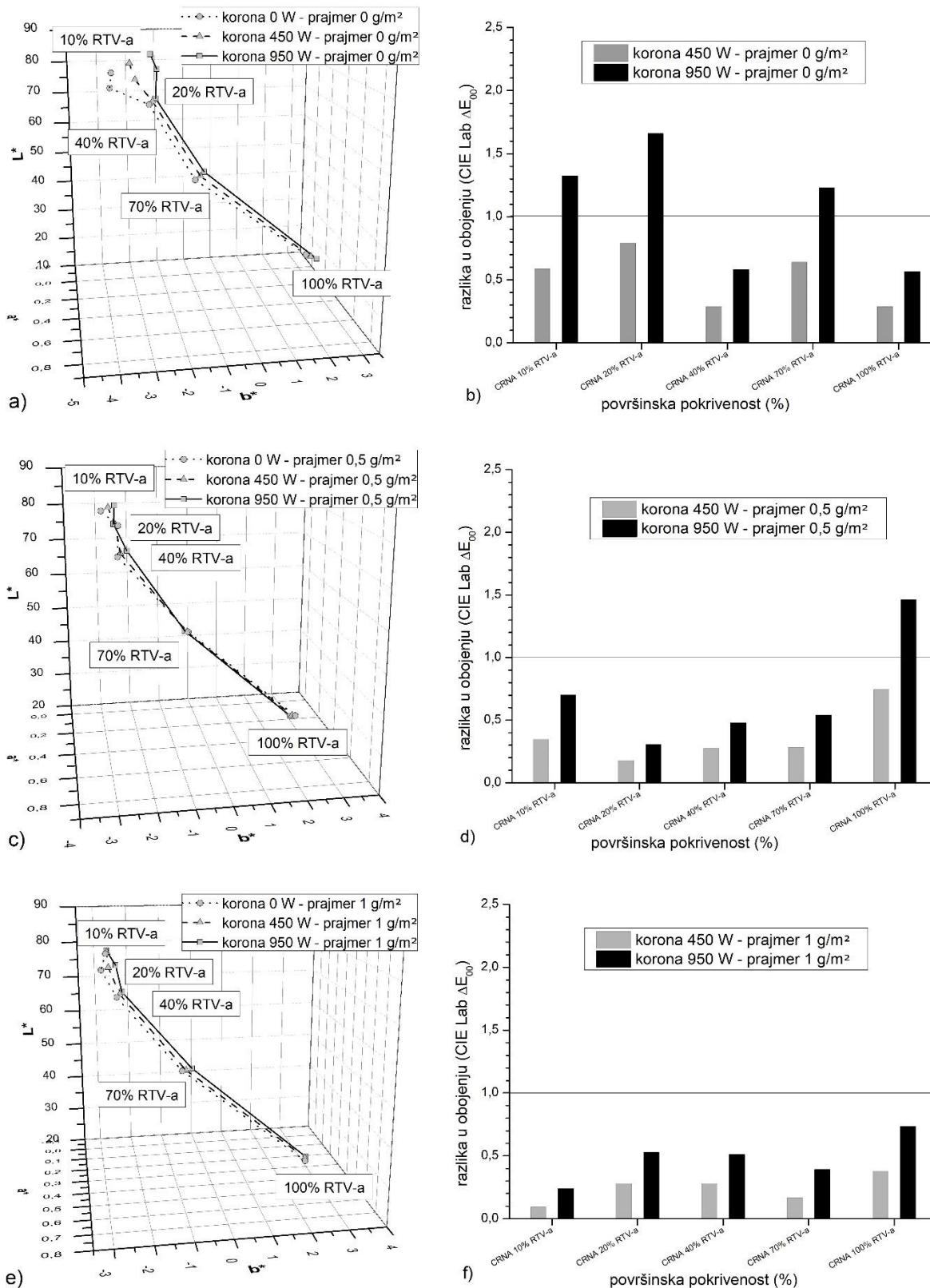
Slika 56. Crni otisci nakon varijacije korone: a) Lab bez prajmera; b)  $\Delta E$  bez prajmera; c) Lab 0,5 g/m<sup>2</sup> prajmera; d)  $\Delta E$  0,5 g/m<sup>2</sup> prajmera; e) Lab 1 g/m<sup>2</sup> prajmera; f)  $\Delta E$  1 g/m<sup>2</sup> prajmera
