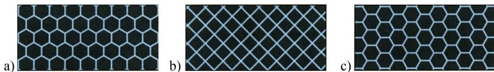
Slika 34. Struktura ćelija na anilox valjku: a) kut od  $60^\circ$ , b) kut od  $45^\circ$ , c) kut od  $30^\circ$
