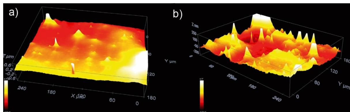
Slika 16. Topografija površine polimernog sloja: a) prije tretiranja koronom, b) nakon tretiranja koronom (Joanna Izdebska, *Printing on Polymers*, poglavlje *Corona treatment*)
