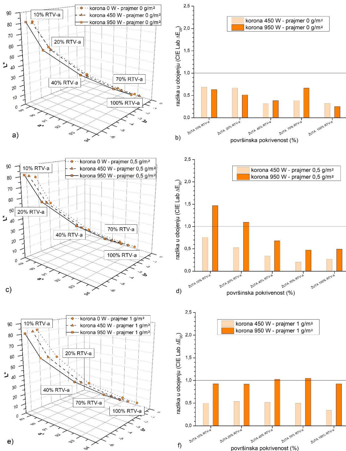
Slika 55. Žuti otisci nakon varijacije korone: a) Lab bez pražmera; b)  $\Delta E$  bez pražmera; c) Lab 0,5 g/m<sup>2</sup> pražmera; d)  $\Delta E$  0,5 g/m<sup>2</sup> pražmera; e) Lab 1 g/m<sup>2</sup> pražmera; f)  $\Delta E$  1 g/m<sup>2</sup> pražmera
