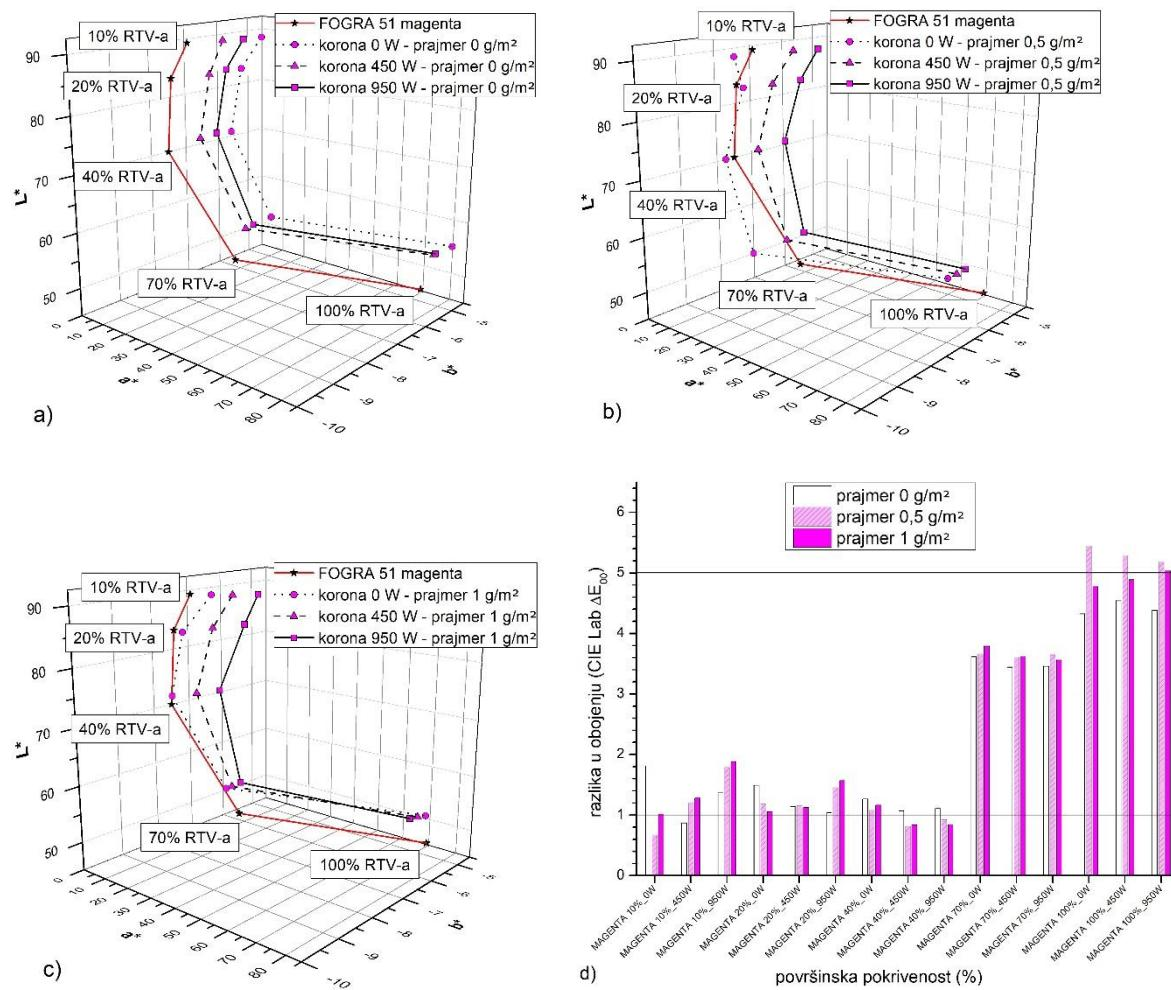
Slika 70. Kolorne promjene magenta otiska nastale varijacijom nanosa prajmera i napona korone u usporedbi s FOGRA standardom: a) bez prajmera; b) prajmer  $0,5 \text{ g/m}^2$ ; c) prajmer  $1 \text{ g/m}^2$ ; d)  $\Delta E$  kolorna odstupanja
