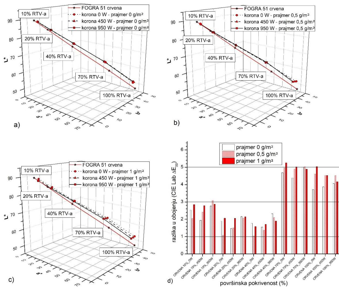
Slika 73. Kolorne promjene crvenih otisaka nastale varijacijom nanosa prajmera i napona korone u usporedbi s FOGRA standardom: a) bez prajmera; b) prajmer  $0,5 g/m^2$ ; c) prajmer  $1 g/m^2$ ; d)  $\Delta E$  kolorna odstupanja
