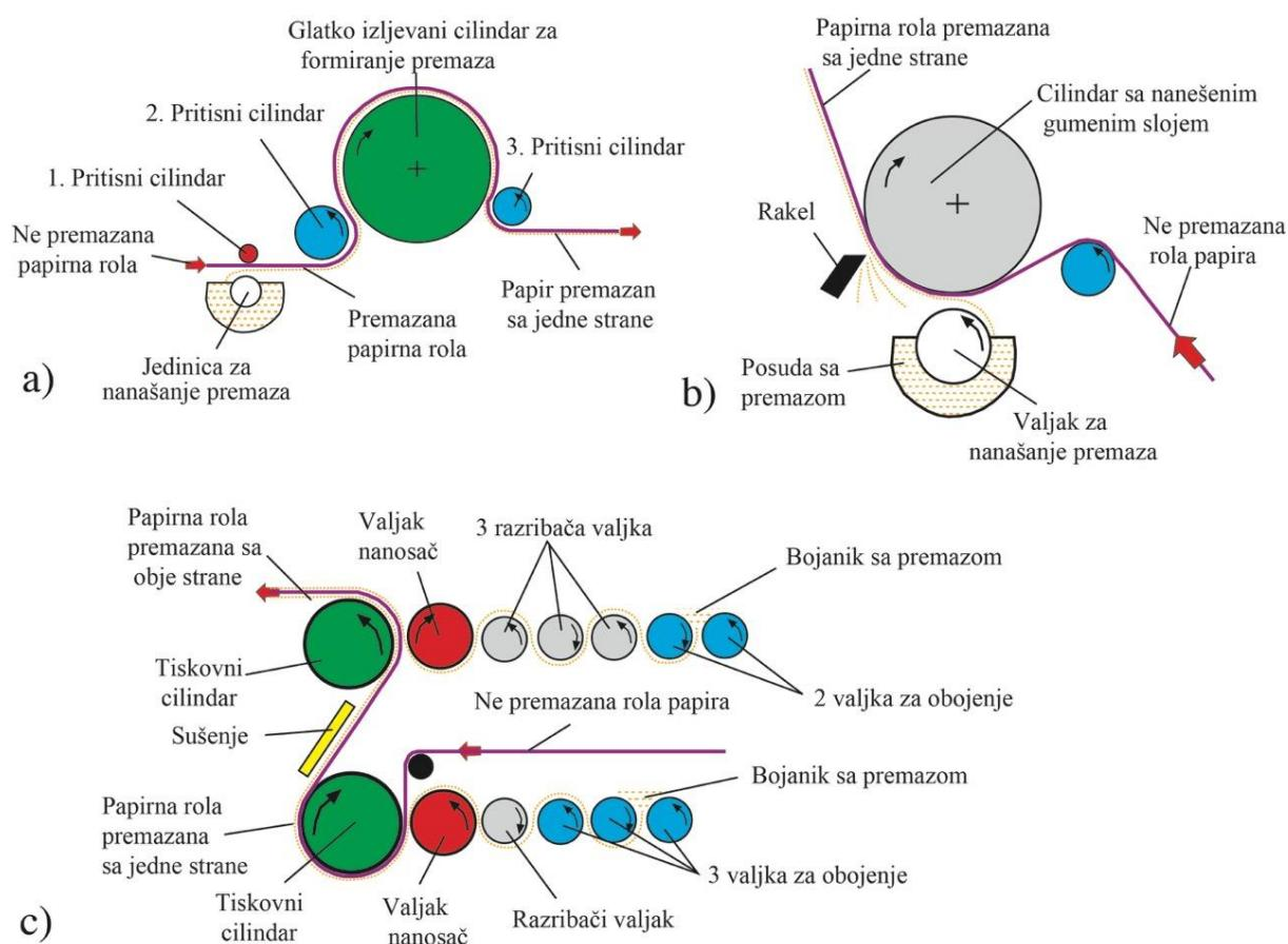
Slika 42. Shematski prikaz metoda premazivanja papira korištenih u grafičkoj industriji:
