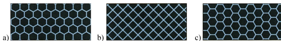
Slika 34. Struktura ćelija na anilox valjku: a) kut od 60°, b) kut od 45°, c) kut od 30°
