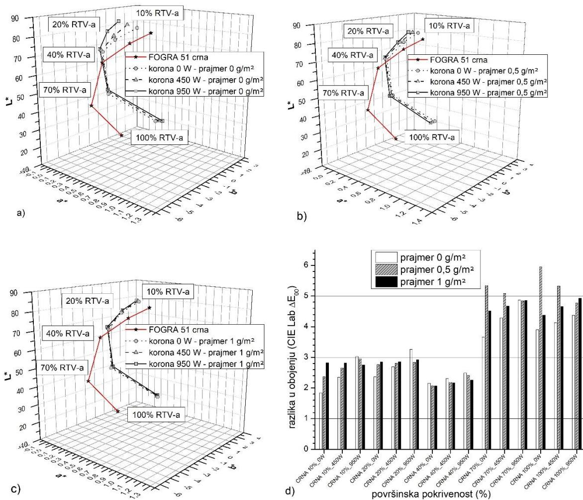
Slika 72. Kolorne promjene crnih otisaka nastale varijacijom nanosa prajmera i napona korone u usporedbi s FOGRA standardom: a) bez prajmera; b) prajmer  $0,5 \text{ g/m}^2$ ; c) prajmer  $1 \text{ g/m}^2$ ; d)  $\Delta E$  kolorna odstupanja
