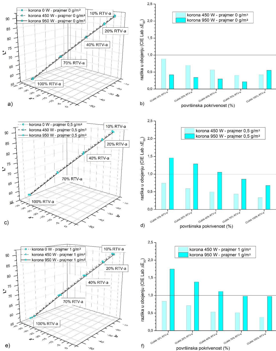
Slika 53. Cijan otisci nakon varijacije korone: a) Lab bez prajmera; b)  $\Delta E$  bez prajmera; c) Lab 0,5 g/m<sup>2</sup> prajmera; d)  $\Delta E$  0,5 g/m<sup>2</sup> prajmera; e) Lab 1 g/m<sup>2</sup> prajmera; f)  $\Delta E$  1 g/m<sup>2</sup> prajmera
