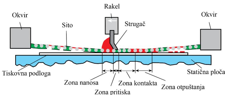
Slika 29. Shematski prikaz principa rada *flatbad* sitotiskarskog stroja
