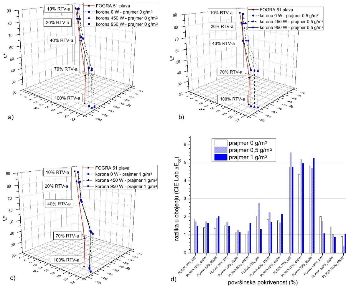
Slika 75. Kolorne promjene plavih otisaka nastale varijacijom nanosa prajmera i napona korone u usporedbi s FOGRA standardom: a) bez prajmera; b) prajmer  $0,5 \text{ g/m}^2$ ; c) prajmer  $1 \text{ g/m}^2$ ; d)  $\Delta E$  kolorna odstupanja
