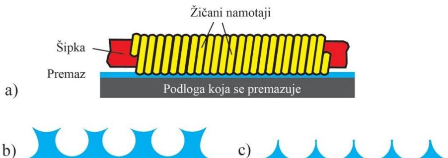
Slika 19. Konstrukcija šipke za premazivanje: a) presjek šipke, b) ostvaren veliki premaz, c) standardni premaz
