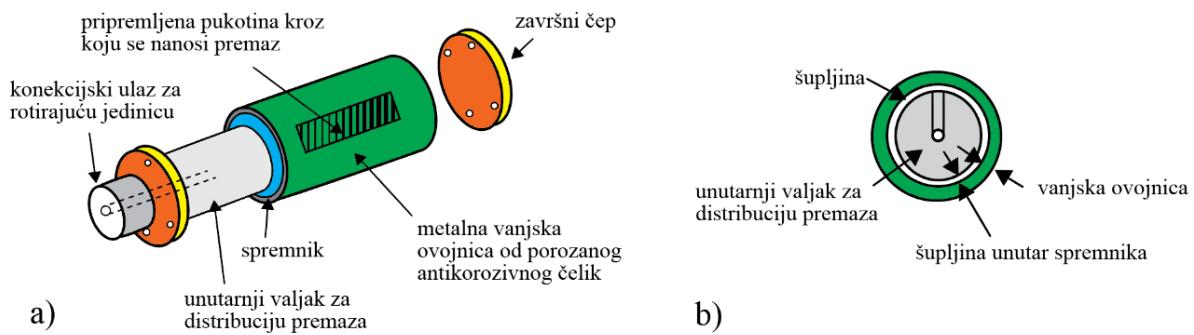
Slika 27. Centralni valjak za premazivanje: a) shematski prikaz valjka, b) presjek valjka
