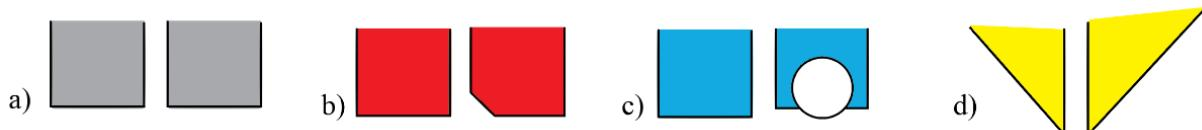
Slika 24. Profili na „T“ obliku jedinice za premazivanje: a) s ravnim rubnim vrhom (duga zona špricanja), b) s ravnim rubnim vrhom (srednja zona špricanja), c) na vršnom rubu (srednja zona špricanja šipkom), d) vršni rub ostvaren oštrim nožem (kratka zona špricanja)
