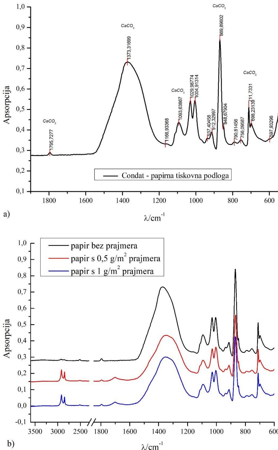
Slika 49. Prikaz FTIR-ova izmjerenih uređajem „Shimadzu IRAffinity-1“ na papiru za umjetnički tisk Condat: a) prije oplemenjivanja, b) nakon oplemenjivanja prajmerom (0,5 g/m<sup>2</sup> i 1 g/m<sup>2</sup>)
