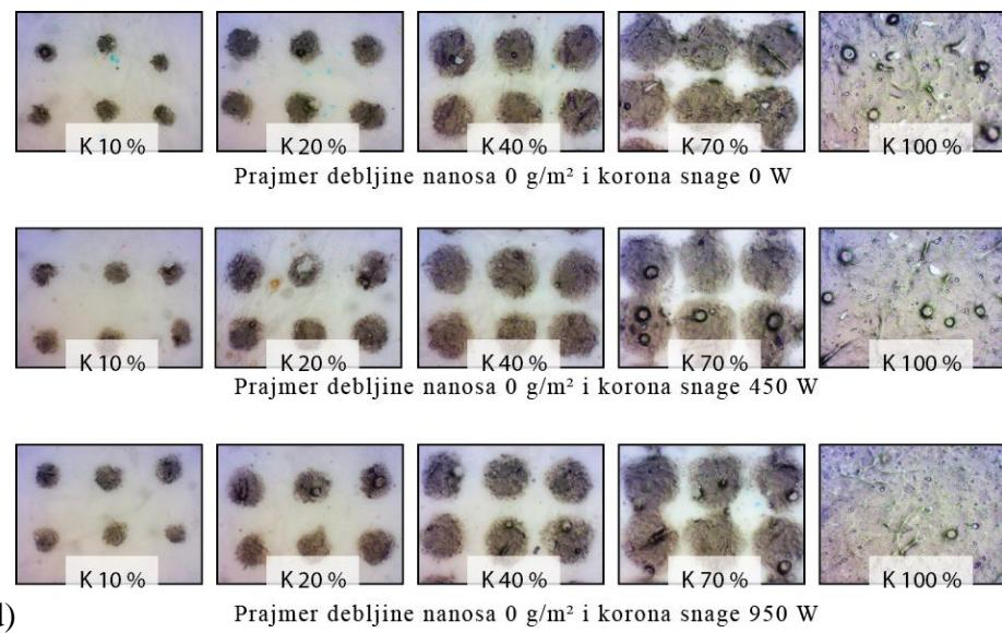
Slika 60. Uvećani HP Indigo otisci bez prajmera uz napone korone (0 W, 450 W i 950 W):
