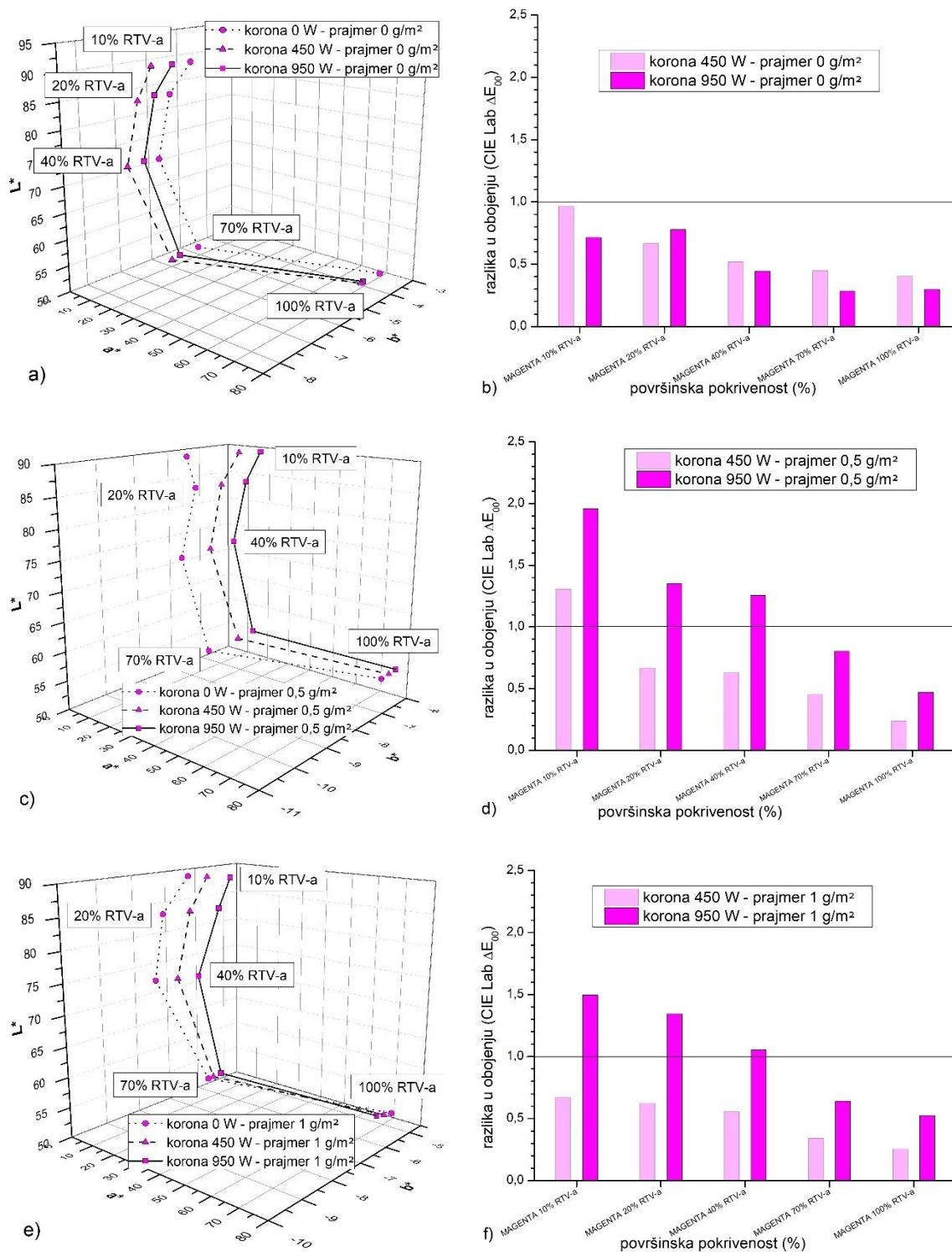
Slika 54. Magenta otisci nakon varijacije korone: a) Lab bez prajmera; b)  $\Delta E$  bez prajmera; c) Lab 0,5 g/m<sup>2</sup> prajmera; d)  $\Delta E$  0,5 g/m<sup>2</sup> prajmera; e) Lab 1 g/m<sup>2</sup> prajmera; f)  $\Delta E$  1 g/m<sup>2</sup> prajmera
