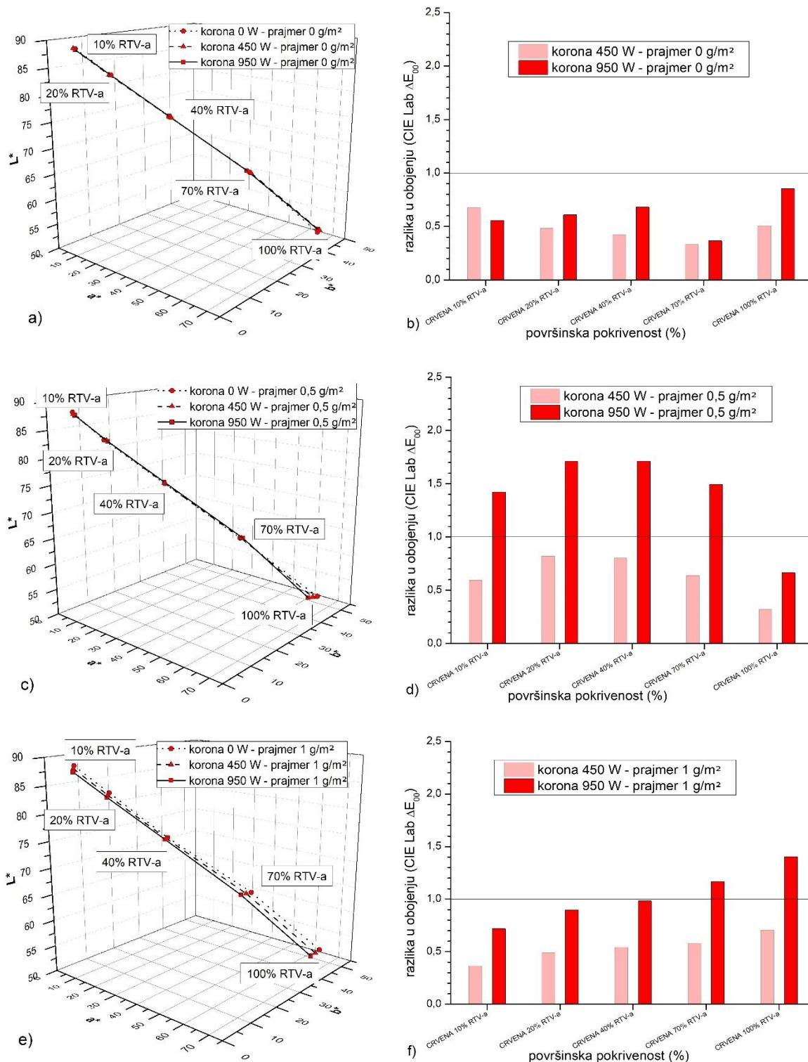
Slika 57. Crveni otisci nakon varijacije korone: a) Lab bez prajmera; b)  $\Delta E$  bez prajmera; c) Lab 0,5 g/m<sup>2</sup> prajmera; d)  $\Delta E$  0,5 g/m<sup>2</sup> prajmera; e) Lab 1 g/m<sup>2</sup> prajmera; f)  $\Delta E$  1 g/m<sup>2</sup> prajmera
