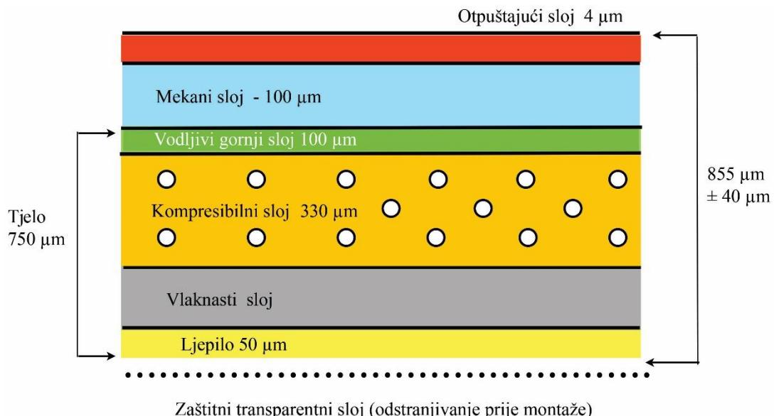
Slika 11. Struktura HP indigo offsetne gumene navlake
