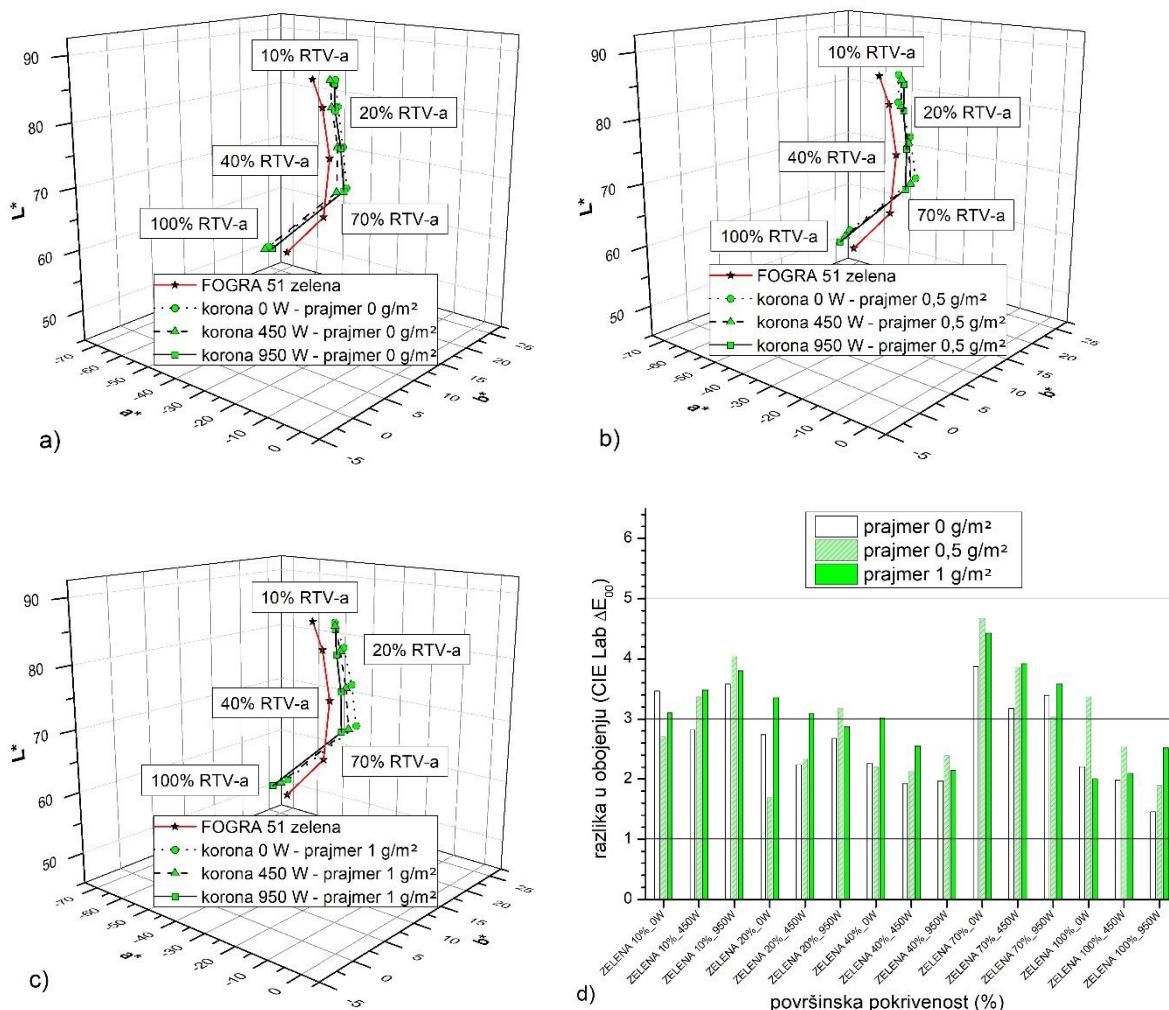
Slika 74. Kolorne promjene zelenih otisaka nastale varijacijom nanosa prajmera i napona korone u usporedbi s FOGRA standardom: a) bez prajmera; b) prajmer  $0,5 \text{ g/m}^2$ ; c) prajmer  $1 \text{ g/m}^2$ ; d)  $\Delta E$  kolorna odstupanja
