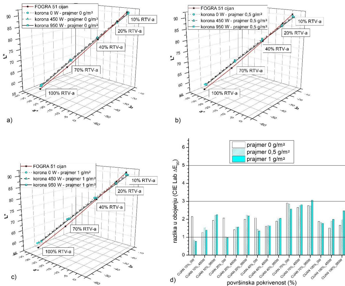
Slika 69. Kolorne promjene cijan otisaka nastale varijacijom nanosa prajmera i napona korone u usporedbi s FOGRA standardom: a) bez prajmera; b) prajmer  $0,5 \text{ g/m}^2$ ; c) prajmer  $1 \text{ g/m}^2$ ; d)  $\Delta E$  kolorna odstupanja
