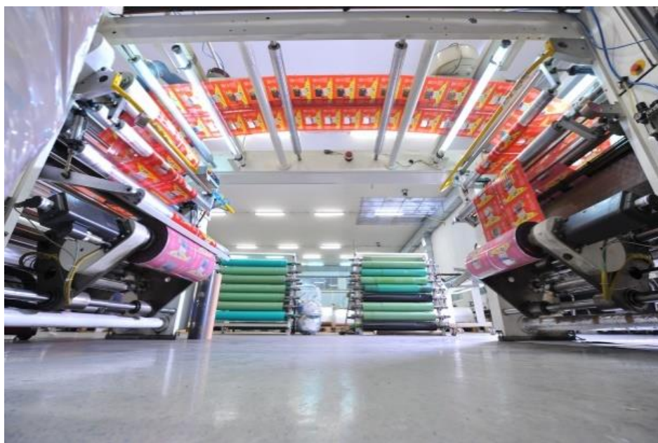
Slika 2.12. Kaširanje na stroju Nordmeccanica Super Simplex.
