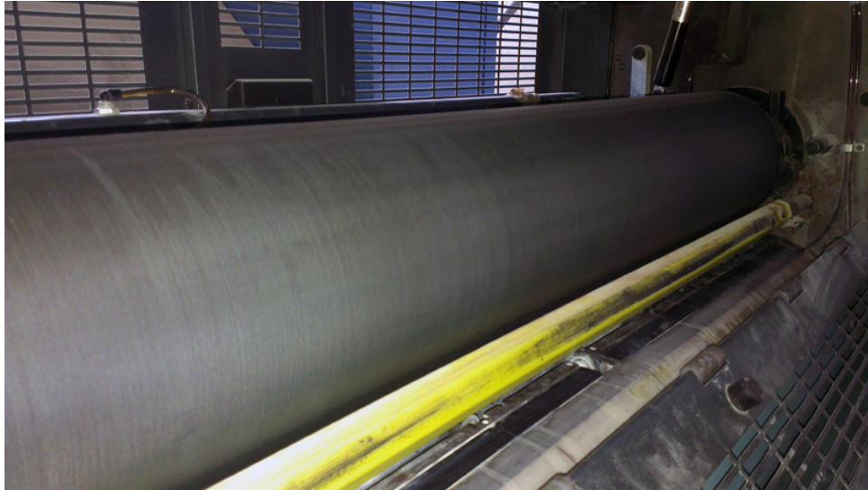
Slika 2.9. Prikaz aniloks raster valjka unutar jedinice za vododisperzivno lakiranje
