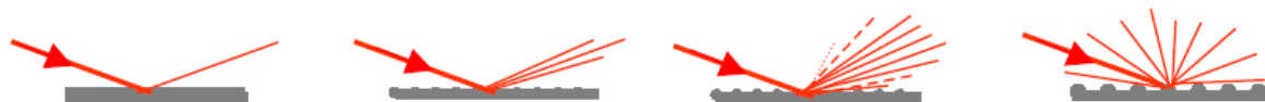
Slika 2.22. Shematski prikaz interakcije upadajuće svjetlosti i promatrane površine s obzirom na hrapavost: a) zrcalna refleksija; b) mala hrapavost uzrokuje minimalno raspršenje; c) veća hrapavost uzrokuje veće raspršenje, ali i dalje u zrcalnom smjeru; d) velika hrapavost uzrokuje raspršenje svjetlosti u svim smjerovima [35]
