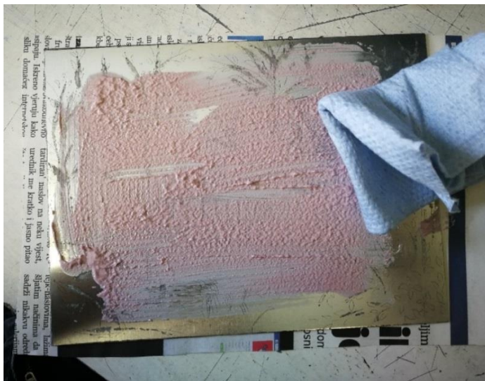
Slika 16. Poliranje pločice pastom
