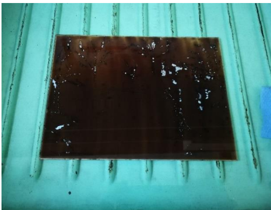
Slika 14. Uklanjanje gumiarabike u toploj vodi
