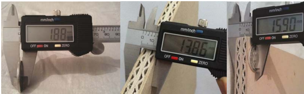
Slika 16. Mjerenje debelog, tvrdog šesteroslojnog valovitog kartona i etalona
