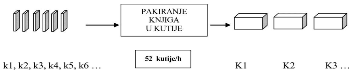
Slika 78 Projektiranje virtualnog procesa za pakiranje knjiga u kutije, gdje su knjige označene sa k1-k6... , a kutije sa K1-K3
