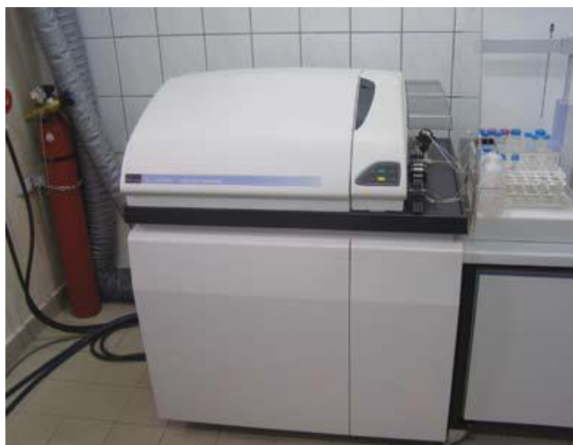
Slika 18. Induktivno spregnuta plazma-maseni spektrometar, ICP-MS (Zavod za opću i anorgansku kemiju, Sveučilište u Zagrebu, Fakultet kemijskog inženjerstva i tehnologije)
