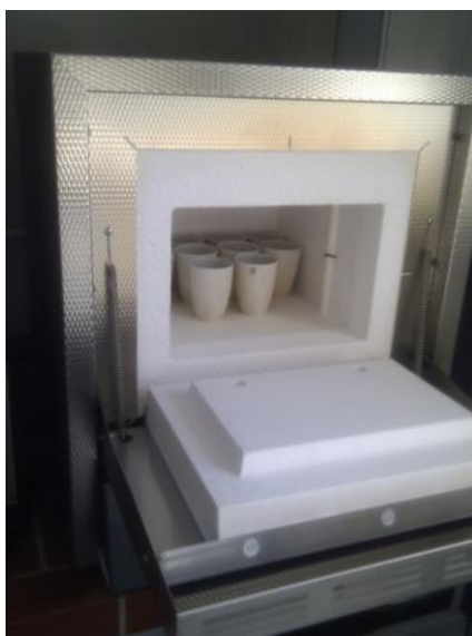
Slika 21. Spaljivanje uzoraka u peći za žarenje (Katedra za kemiju u grafičkoj tehnologiji, Sveučilište u Zagrebu, Grafički fakultet)
