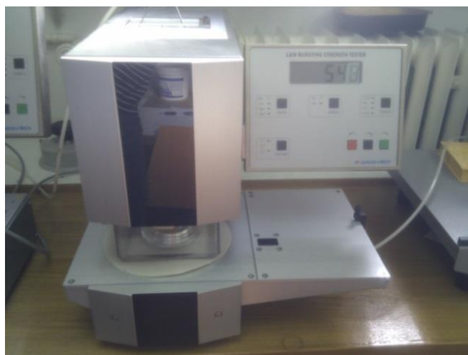
Slika 31. Uređaj za određivanje otpornosti prema prskanju (Katedra za ambalažu, knjigoveštvo i projektiranje, Sveučilište u Zagrebu, Grafički fakultet)
