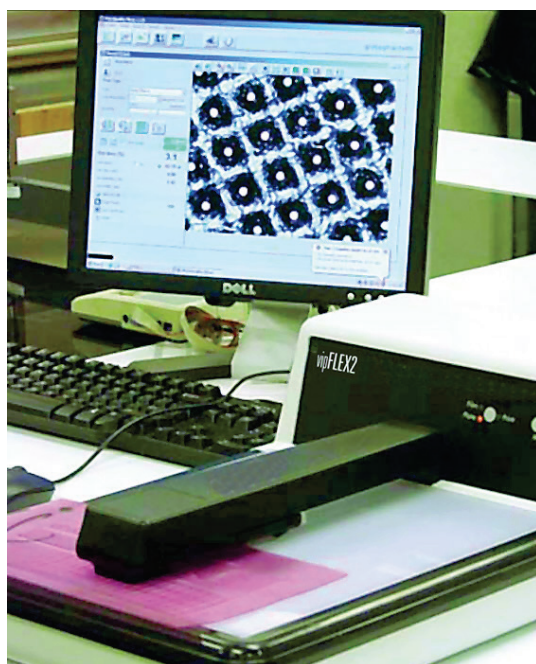
Slika 3.12 Sustav za mjerenje ploča i otisaka: kamera visoke razlučivosti vipFLEX2 i softver PlateQuality Flexo
