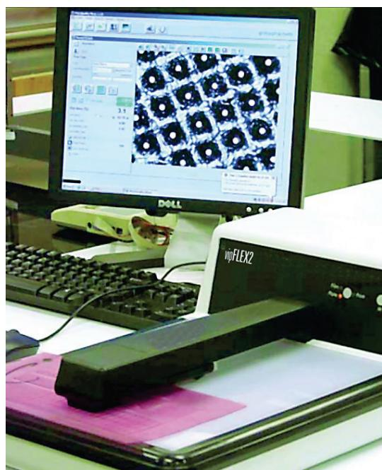
*Slika 3.12 Sustav za mjerjenje ploča i otisaka: kamera visoke razlučivosti
