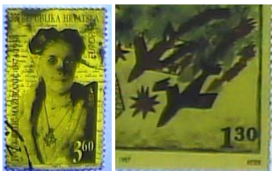
Slika 25. UV premaz preko cijele površine marke
