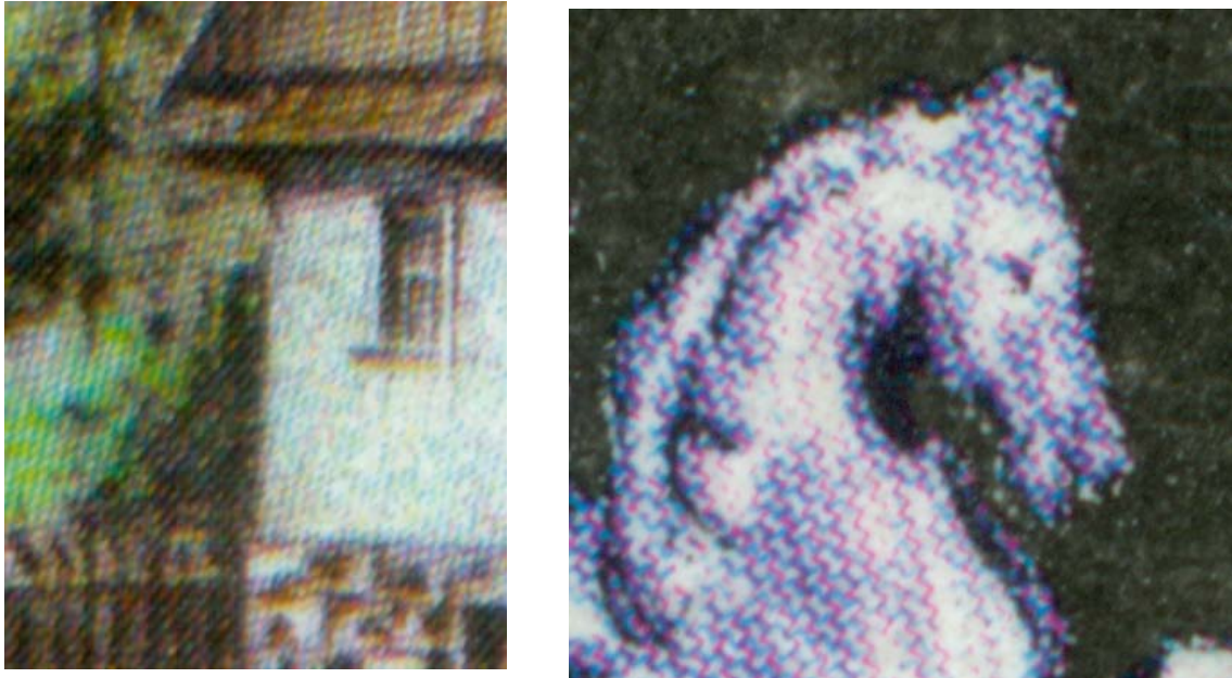
Slika 17. a) K.Čop 1997. detalj marke sa sinusnim rasterom finije linijature; b) N.Žiljak – D.Eljuga 1994. detalj sa sinusnim rasterom grube linijature
