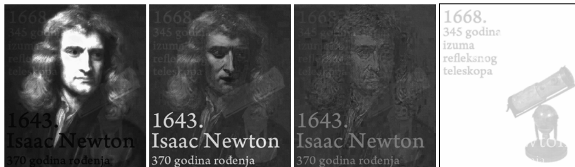
Slika 88. Prikaz CMYK kanala nakon CMYKIR separacije
