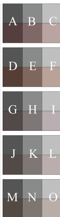
Slika 51. Kontrolni strip za određivanje optimalnog sivog balansa
